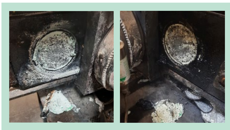
FIGUR 18. Inspektion af smeltefiltre ved lav ekstruderings temperatur (venstre) og høj ekstruderings temperatur (højre) viser sammenlignelige mængder urenheder.
