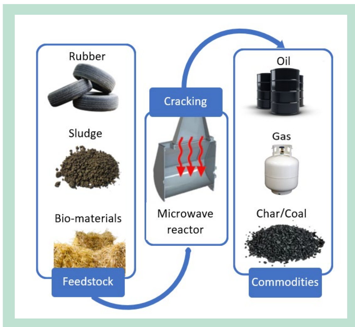
FIGUR 3.2. Illustration af OFT-teknologiens potentielle anvendelsesmuligheder. Processen resulterer i olie, gas og kul/aske. Kvaliteterne og det indbyrdes forhold imellem disse produkter varierer alt efter, hvilket fødemateriale (feedstock) der anvendes.
