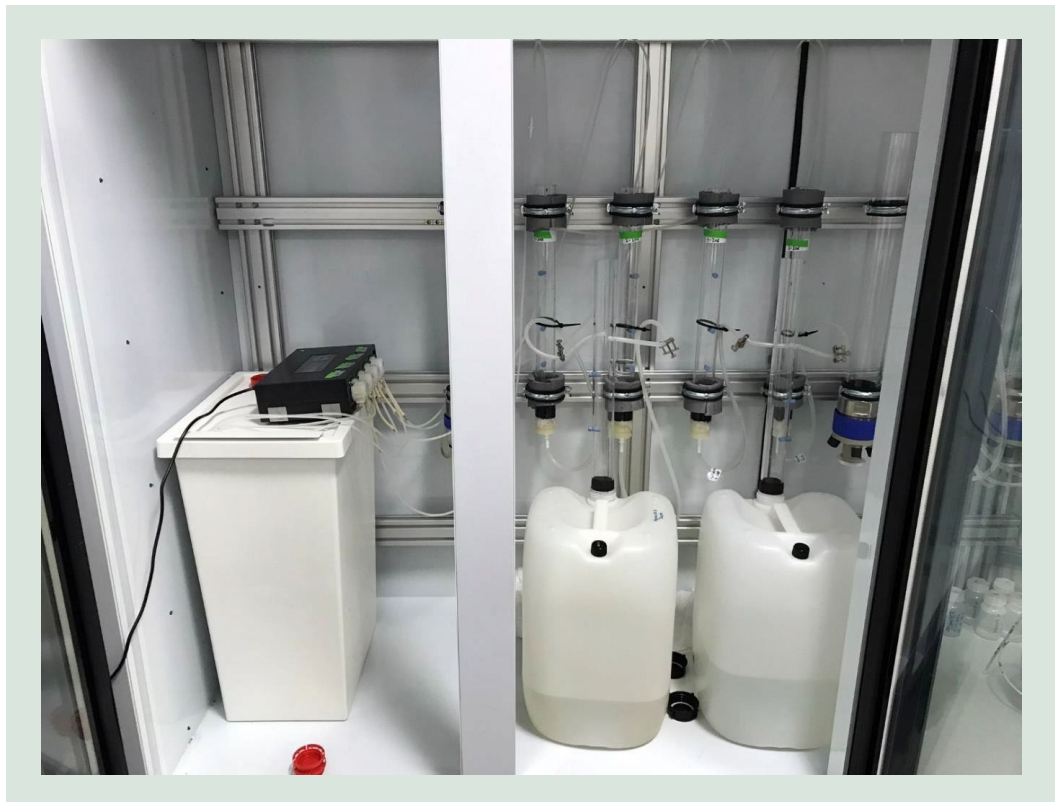
FIGUR 32. Opstilling af kolonneforsøg. Til venstre på billedet er den hvide spand med indløbs-vandet placeret. Indløbsvandet havde en DMS-koncentration på 20 µg/L. De 4 kolonner er på billedet tomme, men blev tilsat 10 g aktivt kul. To kolonner blev tilsat kultypen Silcarbon og to kolonner blev tilsat kultypen Aquasorb CS. Begge kultyper var GAC. Foran kolonnerne kan dunkene til udløbsvandet observeres. Hele forsøget var opstillet i et køleskab indstillet til ca. 10°C for at efterligne forholdene ved et vandværk.
