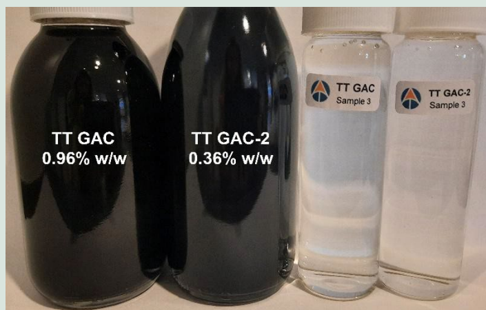
FIGUR 39. Opløsninger fra test af destruktion af aktivt kul brugt hos Ærø Vand til oprensning af DMS og DPC. Fra venstre mod højre er vist: Kulopløsninger på hhv. 0,96% og 0,36% og deres respektive effluentprøver efter destruktion.
