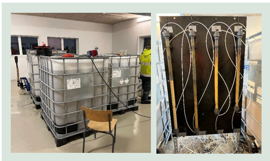
FIGUR 22. Opstilling til adsorptionsforsøg med forskelligt forbehandlet vand (venstre), der blev ført over resinkolonner (højre).
