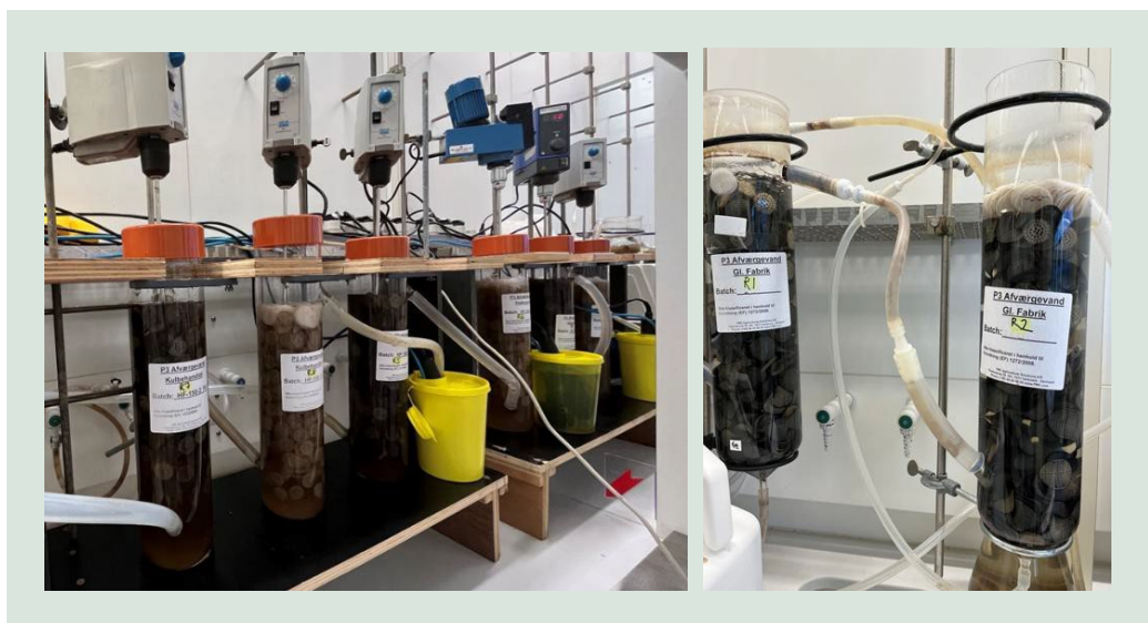
FIGUR 51. De fire MBBR-forsøgsopstillinger i laboratoriet. Fra venstre mod højre R7/R8 Kulbehandlet P3, R5/R6 Flokkuleret P3, R3/R4 Ubehandlet P3 og R1/R2 Gl. fabrik.
