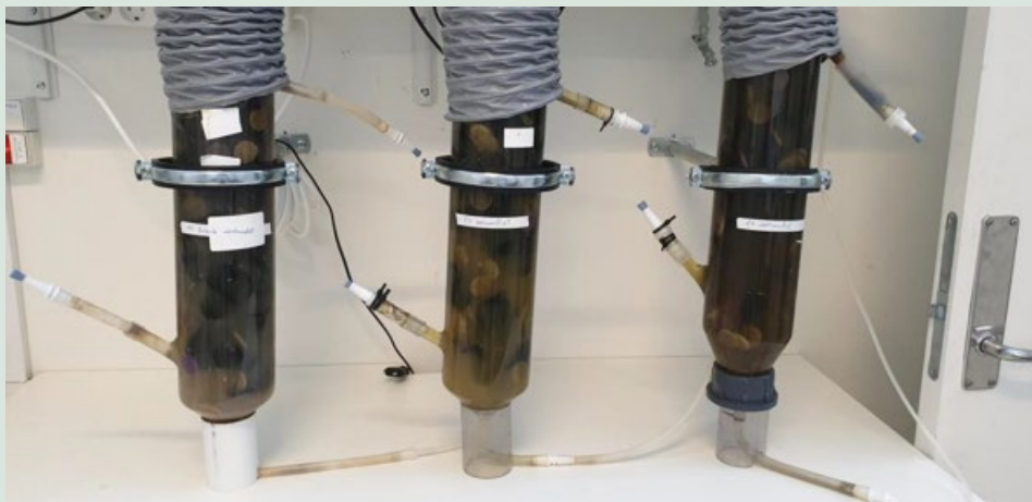
FIGUR 42. Opstilling af Moving Bed Biofilm Reactors (MBBRs) med afværgvand fra FMC. Ven-stre: Gl. fabrik. Midt: P3 forbehandlet med 300 mg/L PAC + koagulering/flokkulering. Højre: Ube-handlet P3. Opstillingen bestod af tre reaktorer (3,25 l) beluftet fra bunden med atmosfærisk luft. Hver reaktor indeholdt en 0,5 L 1:1 blanding af Z- og K5-plastcarriers. De tre reaktorer var isoleret fra hinanden. Vandet havde en opholdstid på 1 uge.
