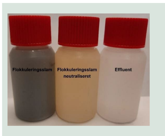
FIGUR 28. Opløsninger fra test 3, subCWO med flokkuleringsslam fra DIN Forsyning. Fra venstre mod højre er vist: flokkuleringsslam, neutraliseret flokkuleringsslam (fødeopløsning) og effluent efter oprensning.
