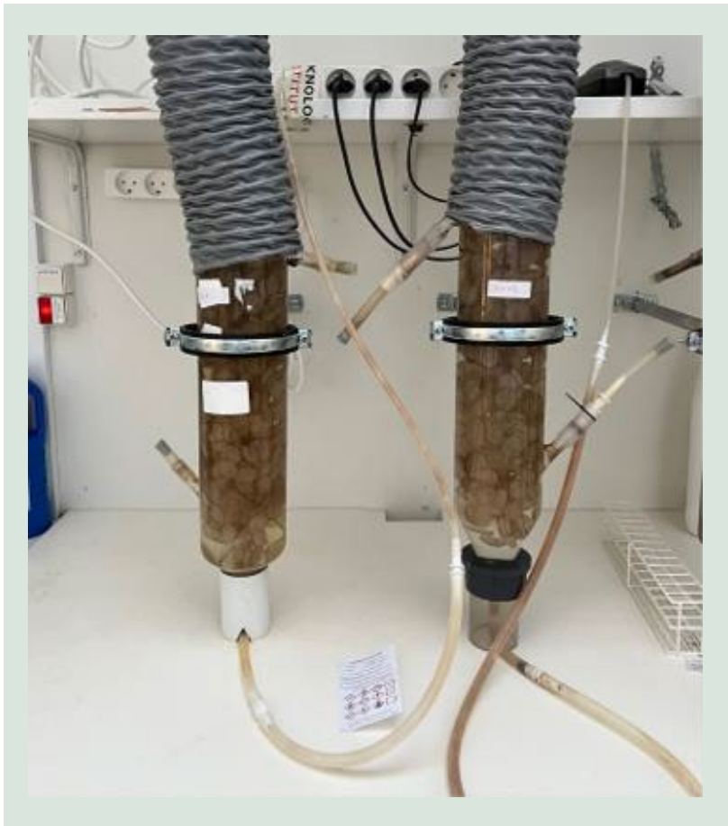
FIGUR 18. MBBR-opstilling i laboratorieskala til fjernelse af bionedbrydeligt, organisk stof.
