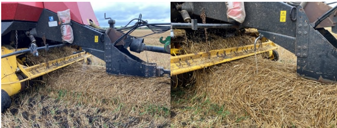
Spredning af eddikesyre med fladdyser (venstre). Spredning af LAB med gødningsdyser (højre).
