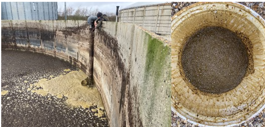
Udtagning af prøve af afgasset gylle fra biogasanlægget ved Skinnerup 6/4 2022 til analyse af viskositet m.m. før anvendelse af ensileret halm.
