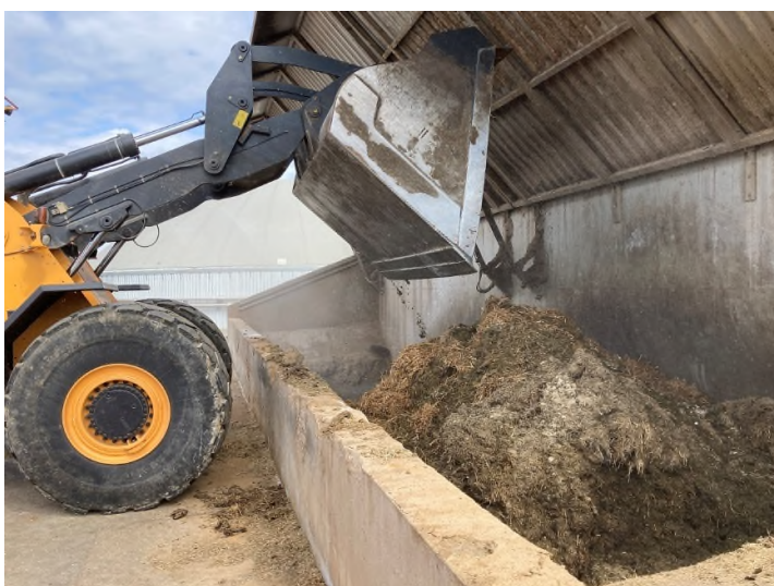
Aflæsning af løsnet halm i blanding med anden biomasse i påslag med walking floor til indfødning af fast biomasse.
