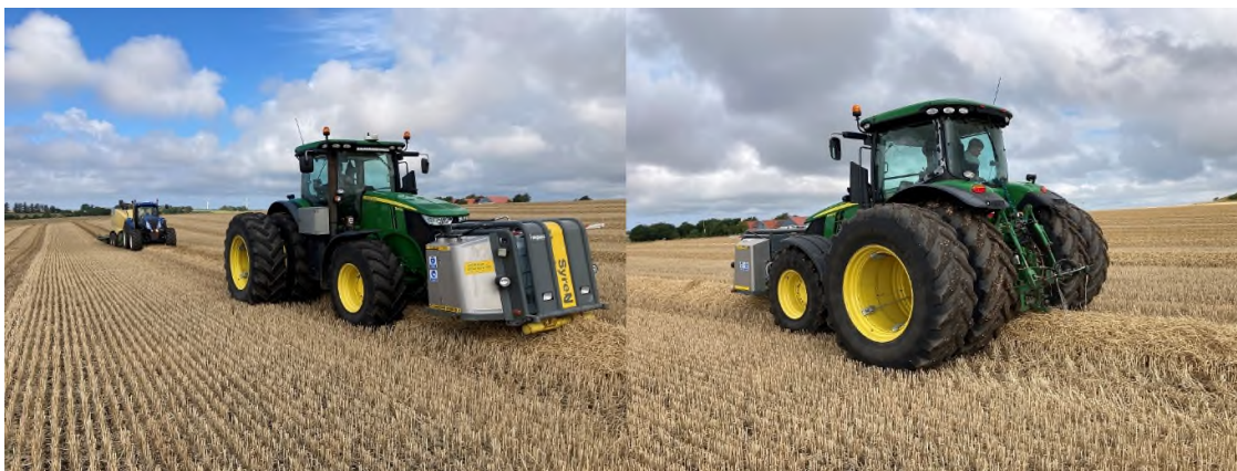
Presning af hvedehalm 27/8 2022 ved Skinnerup Maskinstation. Der blev tilført forskellige ensileringsmidler på halmstrengen med SyreN-anlæg og fladdyser umiddelbart inden presning.
