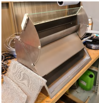
Figur 8: Dimensions-skitse til prototype af innovativt design, samt den første prototype af det innovative design, som skulle testes i emhætte-laboratoriet.
