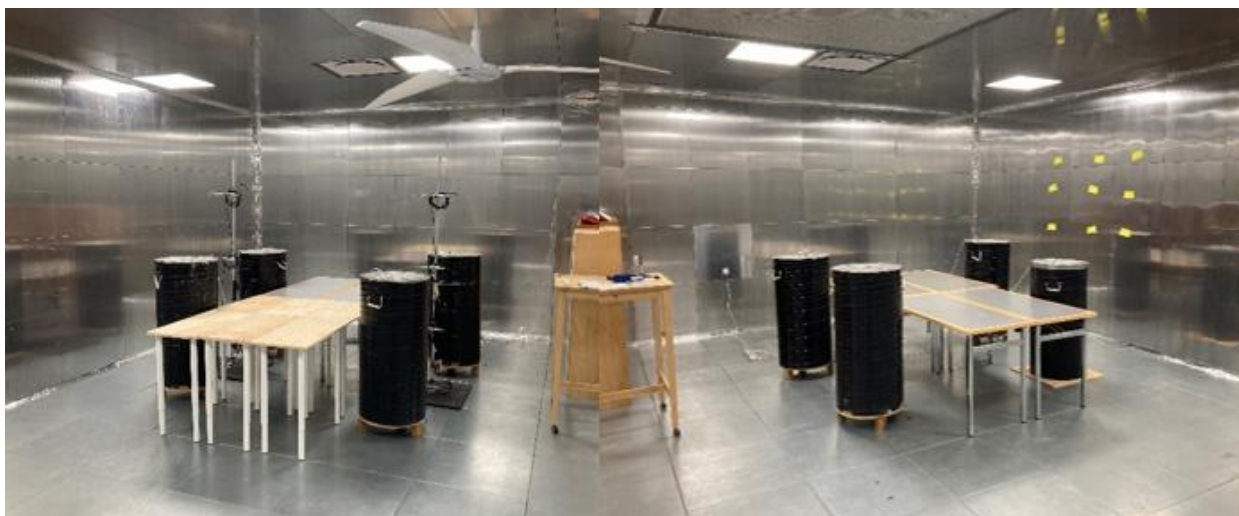
Figur 7. Forsøg i IC. Lab med indretning til 8 kontormedarbejdere, HVLS ventilator Ø2,1 meter og to stk. frisk luft indblæsningsarmaturer
