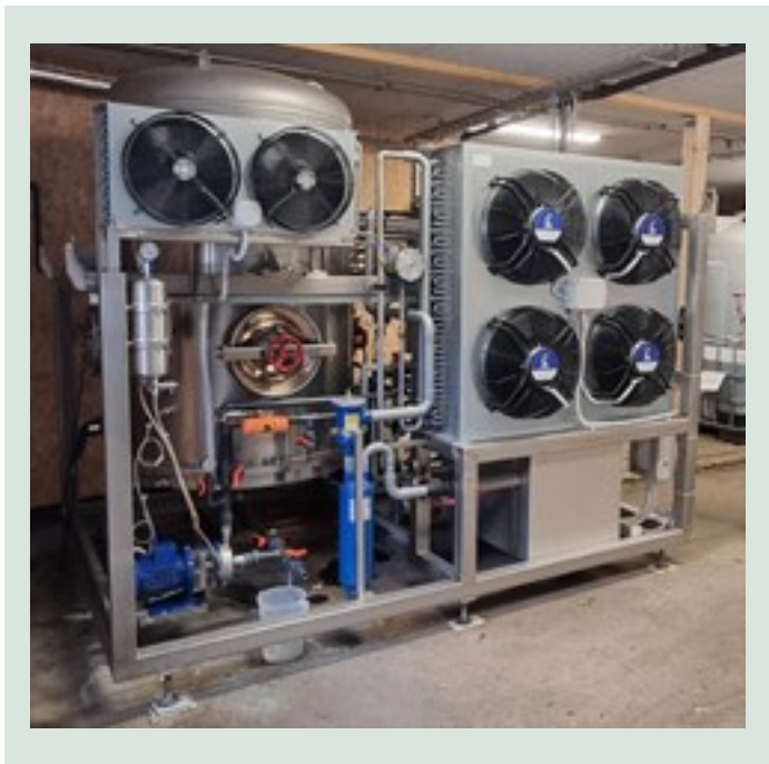
FIGUR 14. Oversigtsbillede der viser inddampnings-anlægget. Blæserne sørger for køling. Kammeret, der er hjertet i vakuuminddamperen, ses bagved de to blæsere i venstre side af fotoet.
