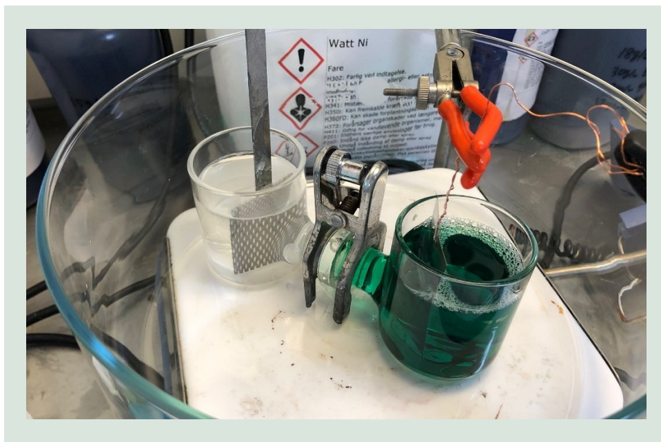
FIGUR 3. Eksempel på en simpel laboratorieopstilling med udfældning af nikkel fra et nikkelbad (grøn opløsning i højre side) med anvendelse af en membran. Anoden er det net af platineret titan der ses i venstre side i den klare opløsning. Membranen er placeret i midten mellem de to kamre og holdes sammen af en klemme.
