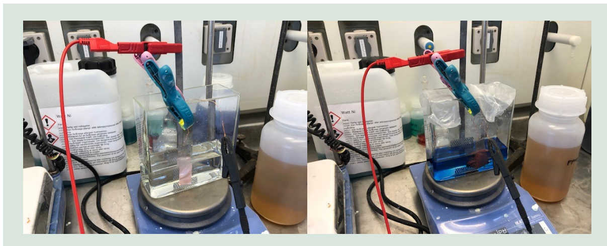
FIGUR 5. Genvinding af kobber fra et kobbercyanidbad. Så længe indholdet af cyanid i badet er højt er badet farveløst, senere når cyanid-ionerne er nedbrudt (oxideret) bliver badet mere blå. På begge foto anes den røde kobberfarve på katoden hvor kobberet udfældes. Anoden er det net der anes bag katoden. Billedet til venstre er efter 7 timer (ca. 18 g/L kobber) og billedet til højre er efter 50 timer (ca. 2 g/L kobber tilbage).
