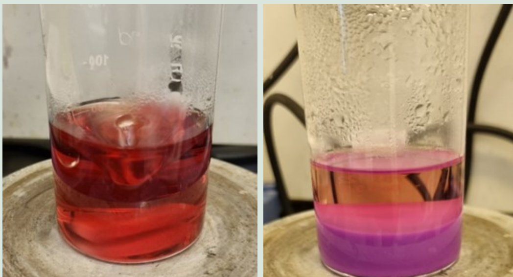
FIGUR 9. Udfældning af kobolthydroxid fra koncentreret spildevand (dunk 7 i TABEL 5). Indledende fældning fra filtratet efter bortfiltrering af ammoniumfosformolybdat (venstre) og bundfældning og klaring af kobolthydroxid (højre).
