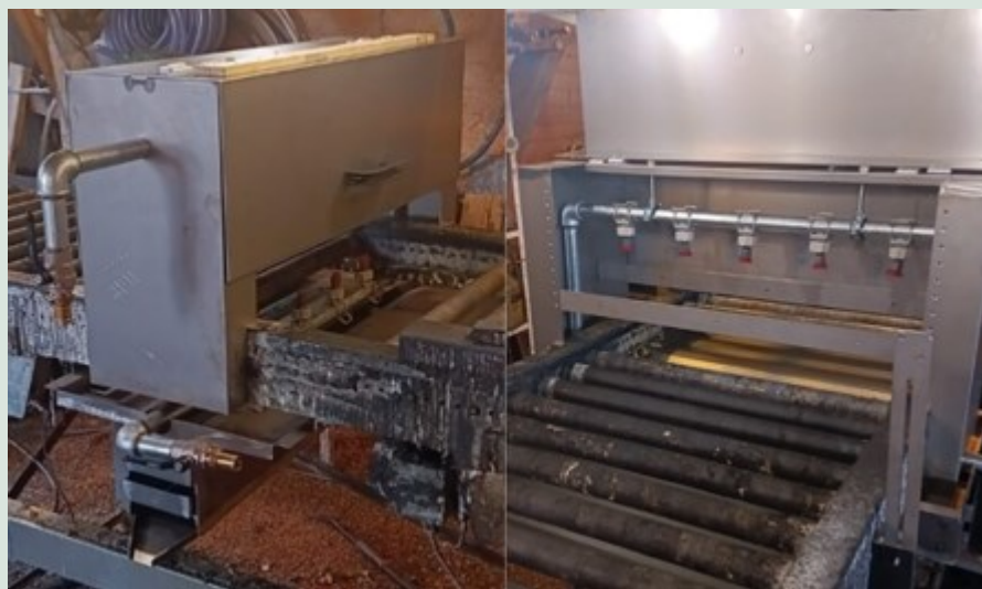
FIGUR 9. Spraykabine Version 2 i Produktionen ved BurntWood. Fotografi, Troels Nyholt.
