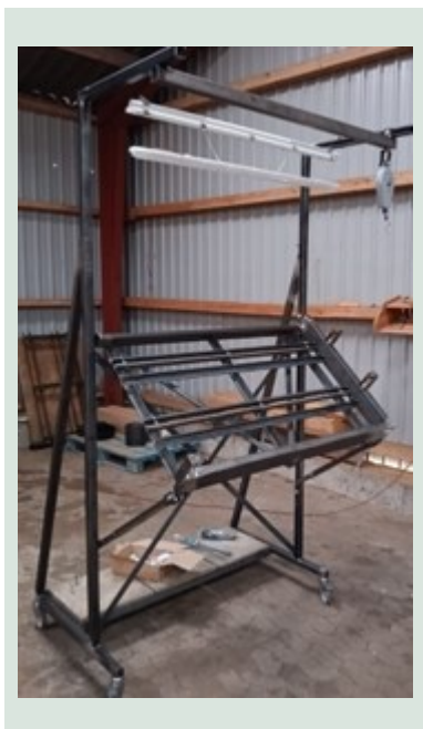
FIGUR 2. Elementskabelon i produktionen ved BurntWood. Fotografi, Troels Nyholt.
