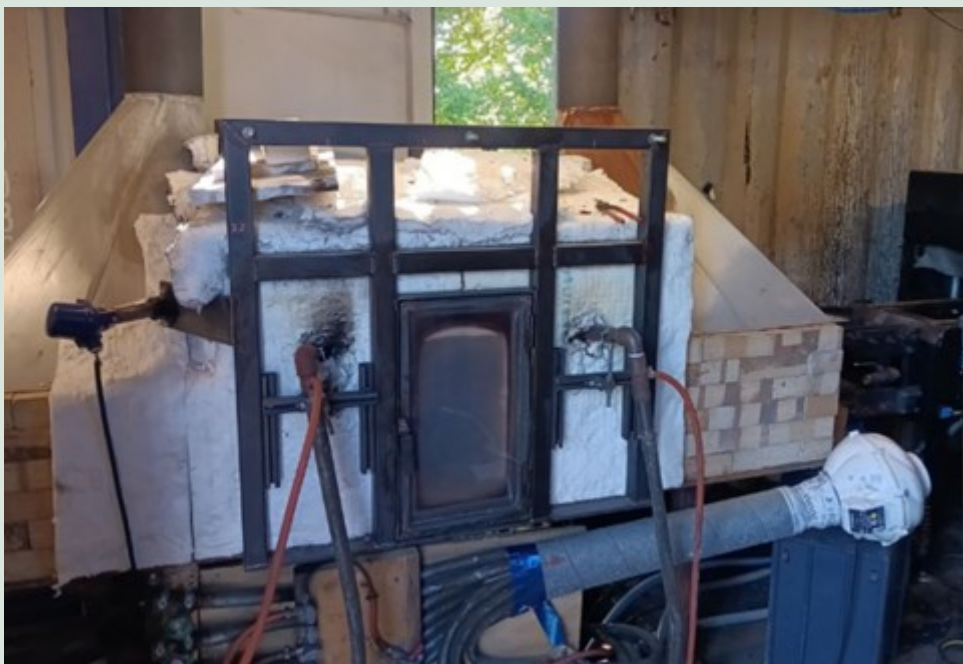
FIGUR 6. Omdesignet ovn med selv bærende brænding. Fotografi, Troels Nyholt.
