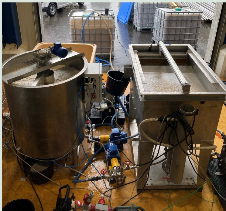
FIGUR 12. Pilotskalaflotationsanlæg fra BIO-AQUA der blev anvendt til pilotforsøg til parallel og seriel drift.
