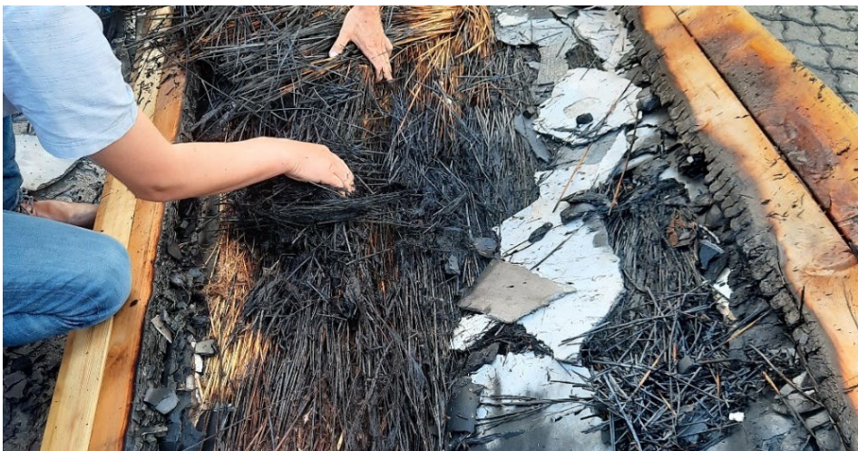
Figur 15. Undersøgelse efter testen, der vises bagsiden af emnet, hvor vi ser at bagbeklædning har været eksponeret.
