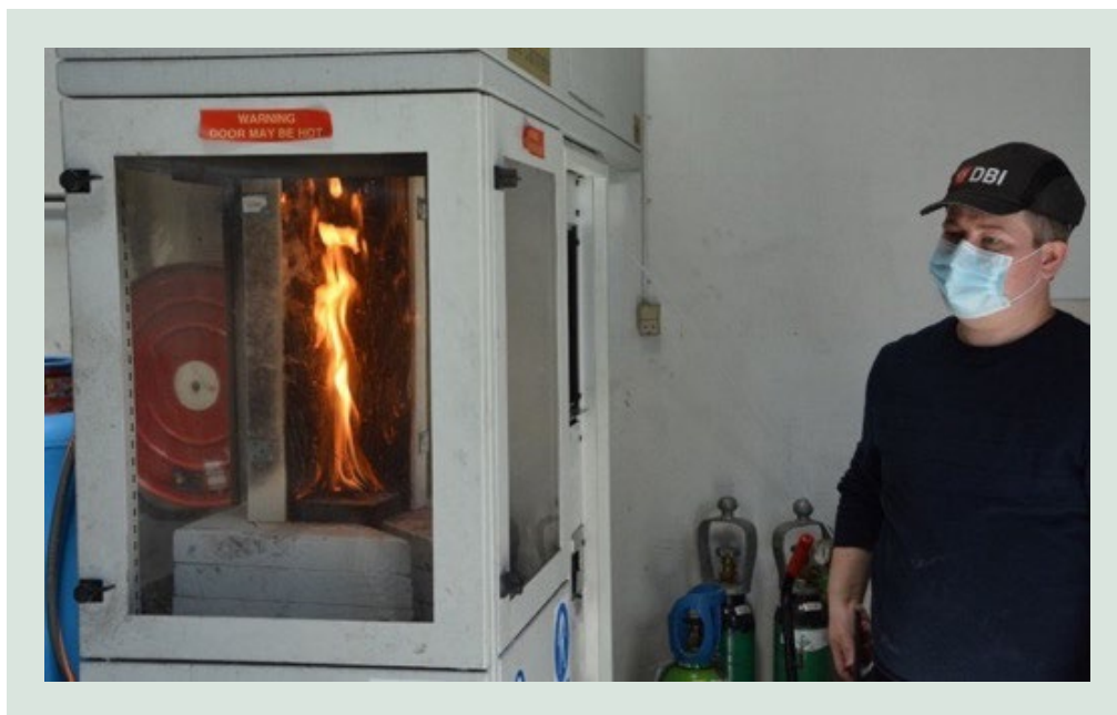
FIGUR 4. Her ses brændkammeret til Mini-SBI test med Mads Hohlmann fra DBI, som stod for at eksekvere brandtestene. Foto: Jørgen Kaarup.
