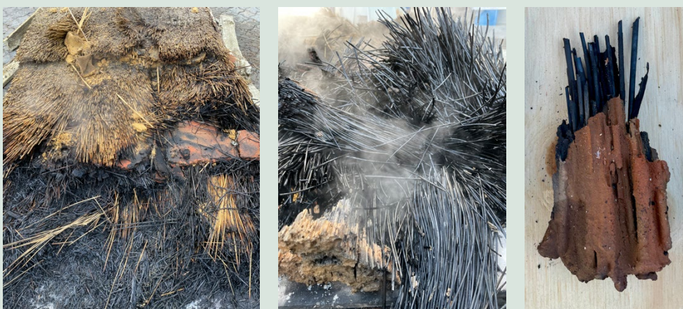
FIGUR 9. Forkullede tagrør bundet i lerjordens brændte keramiske form – fund af rester efter brandtest. Foto Anne Beim.
