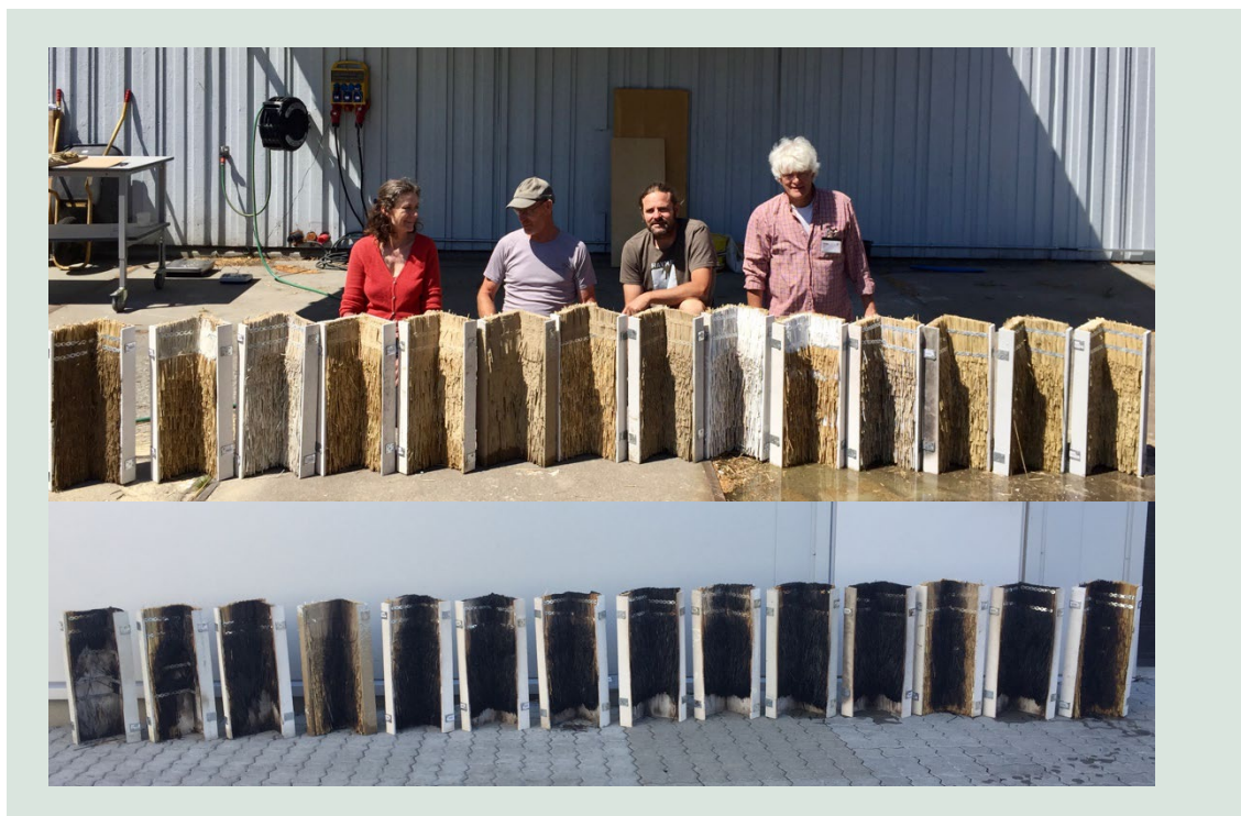
FIGUR 7. 'Før og efter' af de 14 Mini-SBI brandtest med imprægnerede lodret tækkede flader. Foto: Anne Beim.
