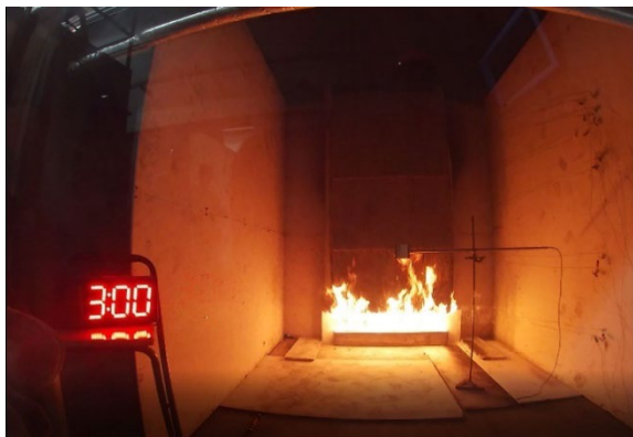
Figur 21. Test 2 – Sprøjtet med ler og indbyggede lerplader efter 3 min
