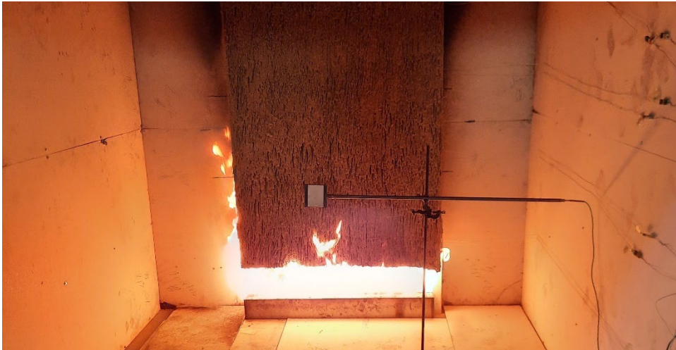
Figur 14. Flammerne antænder bagvedliggende konstruktion
