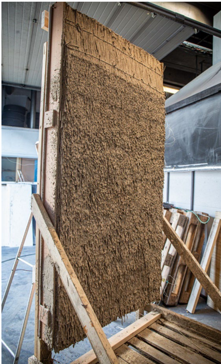
Figur 10. Testemnet med sprøjtet moræneler
