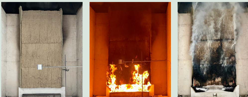
FIGUR 8. Fuldskala testemne med påsprøjtet ler, der også havde indbygget plader af ler mellem lagene af strå. Før, under brandprøvning og efter 30 min. Foto Anne Beim.
