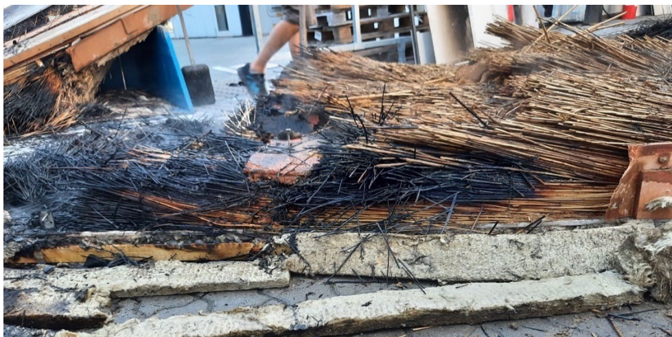
Figur 18. Undersøgelse af lerpladens beskyttende virkning. En af lerpladerne er blotlagt og intakt
