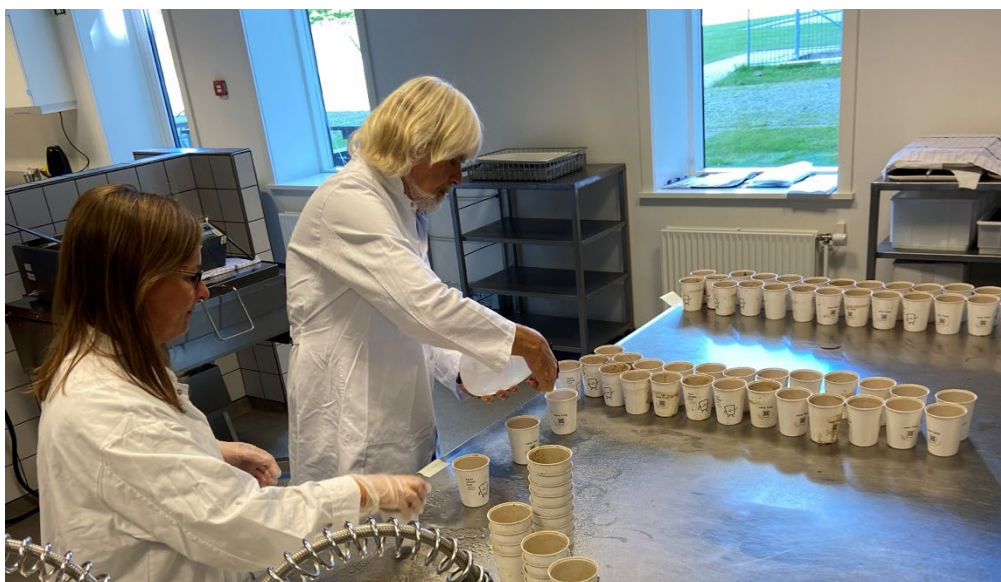
Test med kaliumsorbat på kopper i laboratoriet hos Teknologisk Institut.
