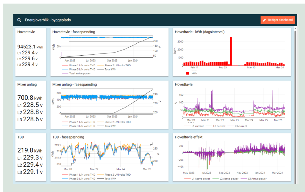
FIGUR 4. Her vises et udklip fra dashboard på Oaksystem.io fra KM ConneX for et energi-overblik på byggepladsen.
