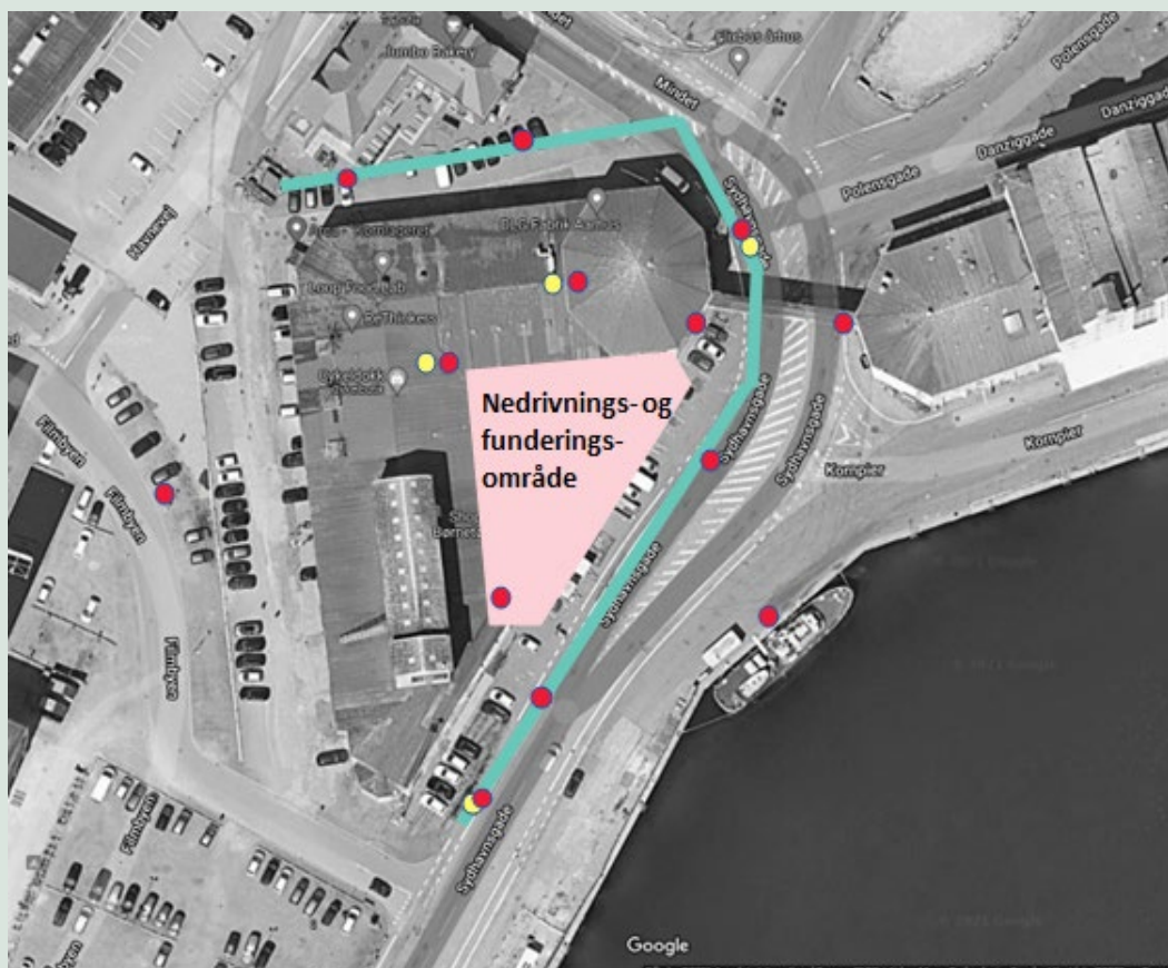
FIGUR 14. Overblik over sensornetværket som det så ud i oktober 2023. De røde prikker er gas- og partikelsensorer og de gule prikker er støj- og vindsensorer.
