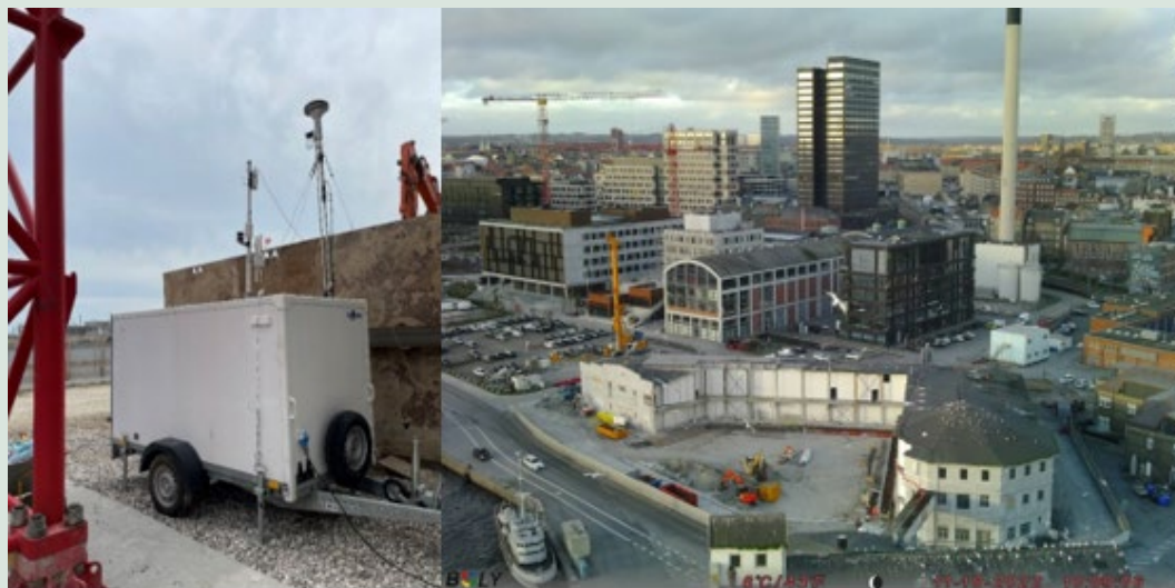
FIGUR 2. Måletrailer på byggepladsen til on-site-validering af sensornetværkets partikelmålinger.
