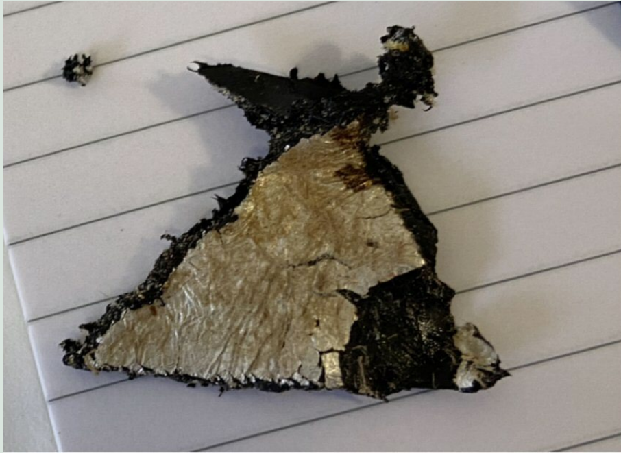
FIGUR 74. Bitumen/klister plus aluminiumslag op ad kapperør (L6).
