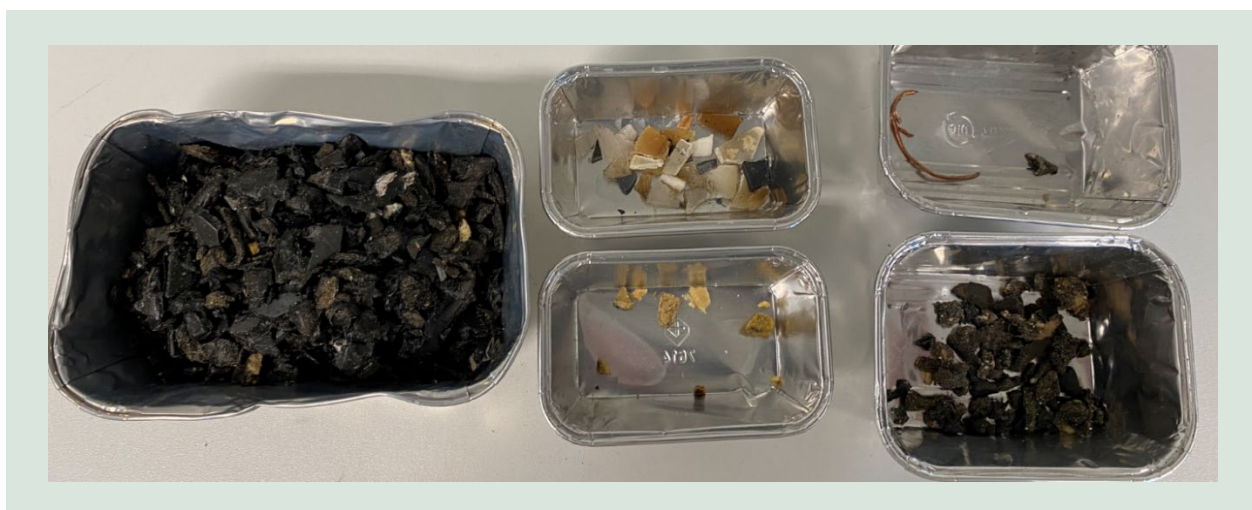
FIGUR 40. Sortering af HDPE-fraktion fra rør med CFC, 1 gang vindsigtning: Tv.: HDPE. Midt øverst: Klar, hård plast. Midt nederst: Skum. Th. øverst: Kobbertråde. Th. nederst: Bitumen.
