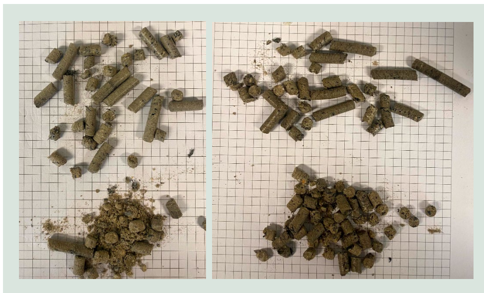
FIGUR 44. Pressede piller af PUR. Tv.: Med CFC. Th.: Uden CFC.
