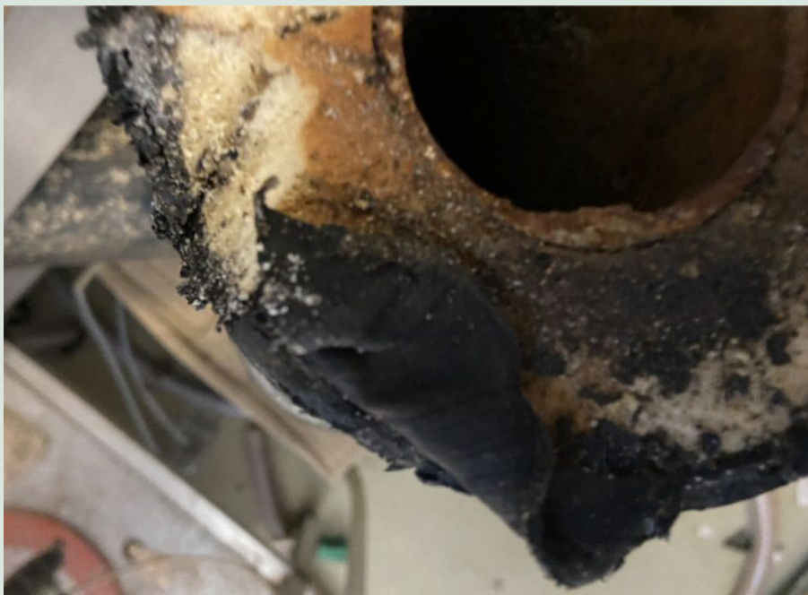
FIGUR 75. PE-lag op ad kapperør (L7).
