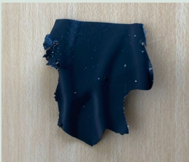
FIGUR 71. Folielag (PE) op ad medierør (L3).
