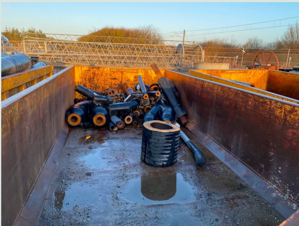
FIGUR 28. Type 3: Frasorterede rør uden CFC.
