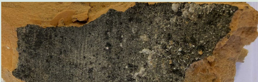
FIGUR 73. Bitumen/klister op ad skum ved kapperør (L5).
