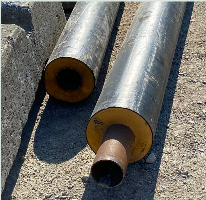
FIGUR 2. Fjernvarmerør med stålmedierør, PUR-isolering og HDPE-kappe.
