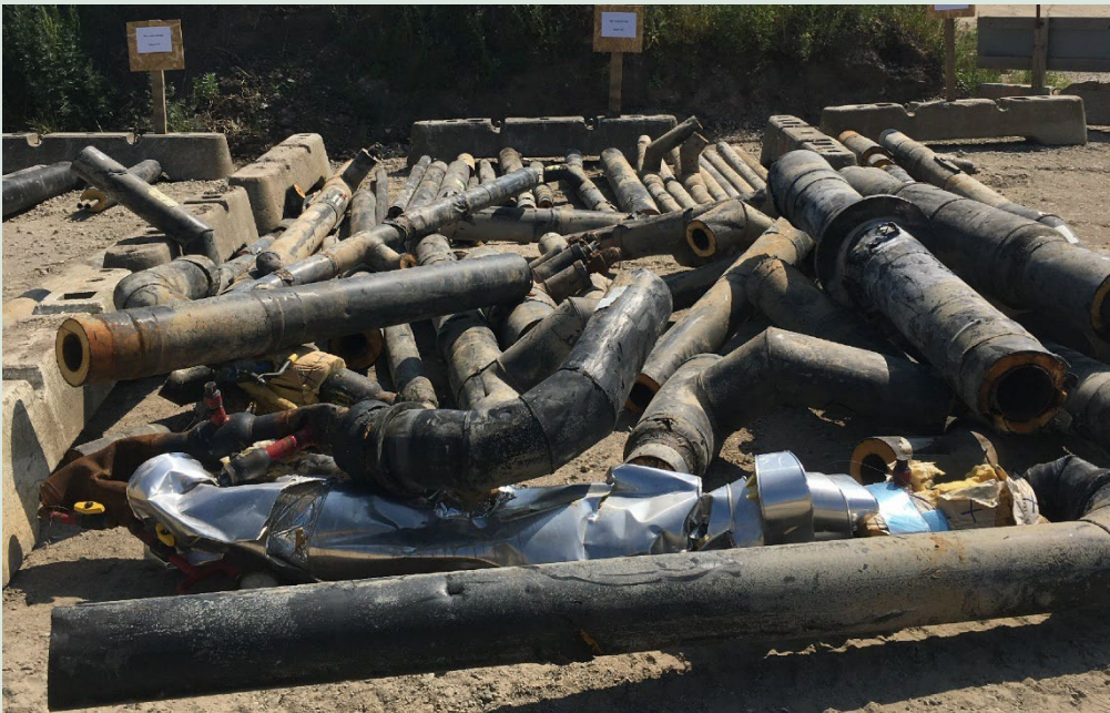
FIGUR 23. Type 3: Rør med bitumenmellemlag/andet problematisk, med CFC.
