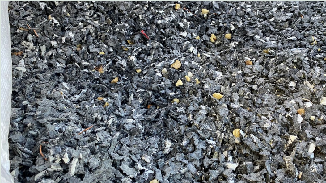
FIGUR 45. Input (der ses indhold af kobbertråde og skum. Der ses desuden lag af aluminium på HDPE fra kapperørene).
