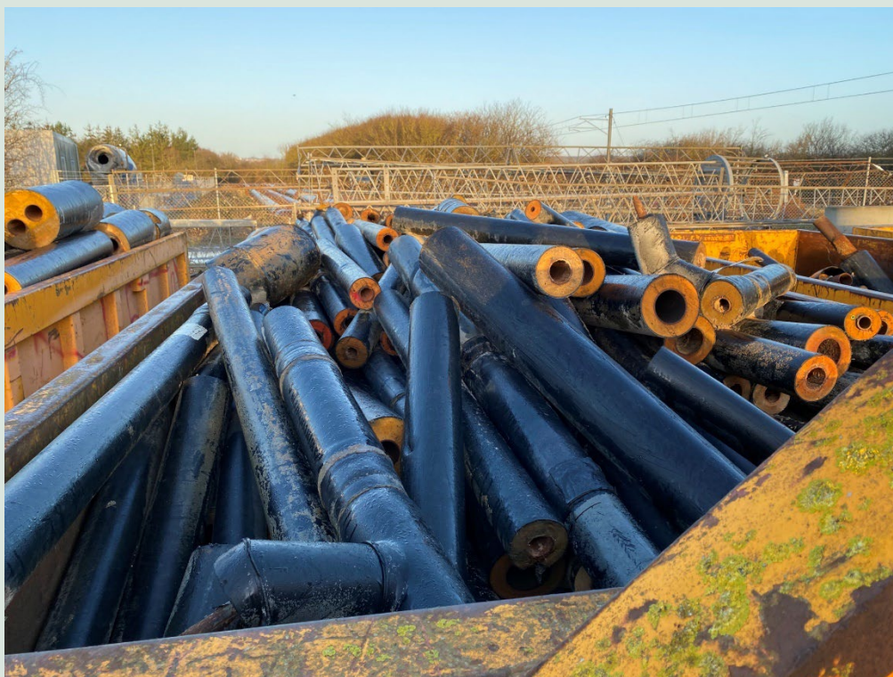
FIGUR 26. Type 1: Forbehandlede rør, uden mellemlag med CFC.
