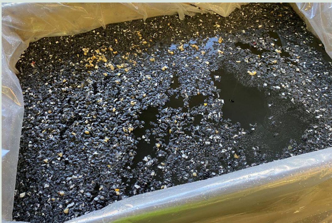
FIGUR 46. Manuel separation af HDPE i flydekar (rester af skum flyder ligeledes).
