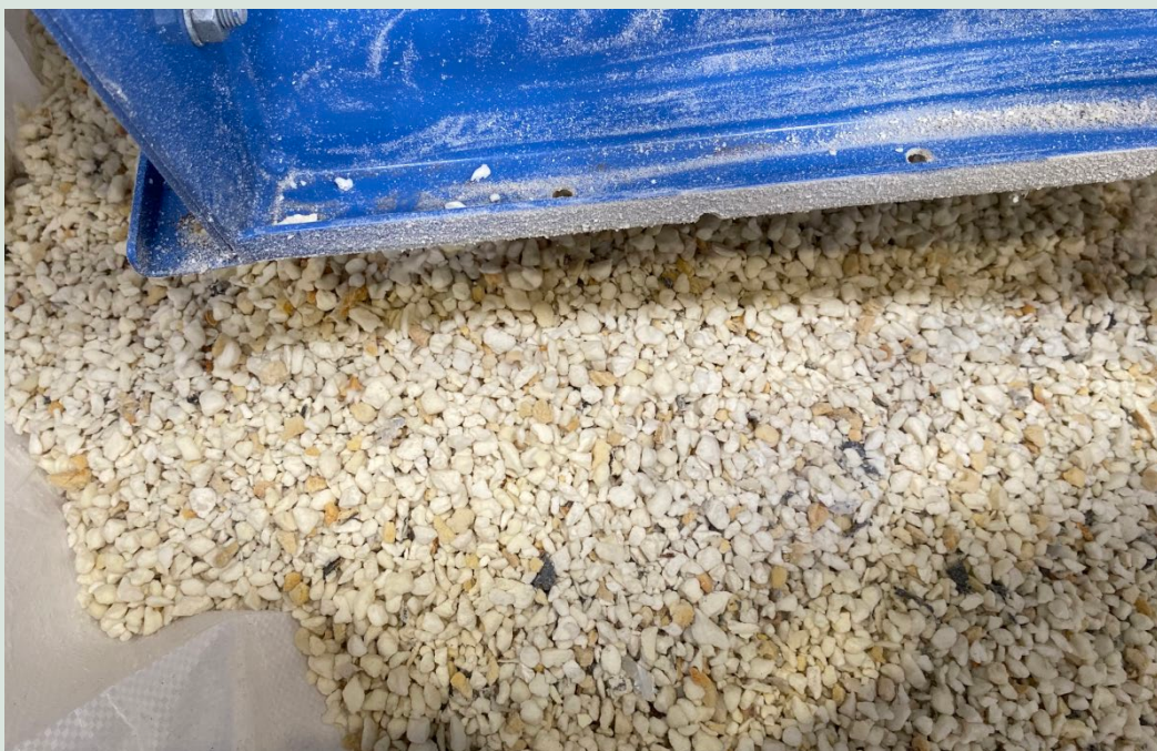
FIGUR 37. Skum fra materiale uden CFC (2 gange vindsigtning).
