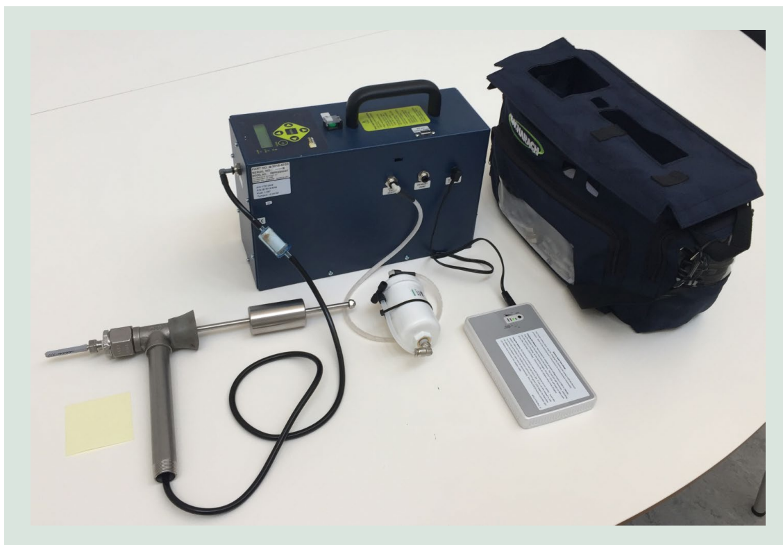
FIGUR 10. CFC-sensorens komponenter er vist (fra venstre): Probe til indføring af rawplug i en blotlagt ende af et fjernvarmerør, IR-måleinstrument, kulfilter til nul-luft, batteri og bæretaske.
