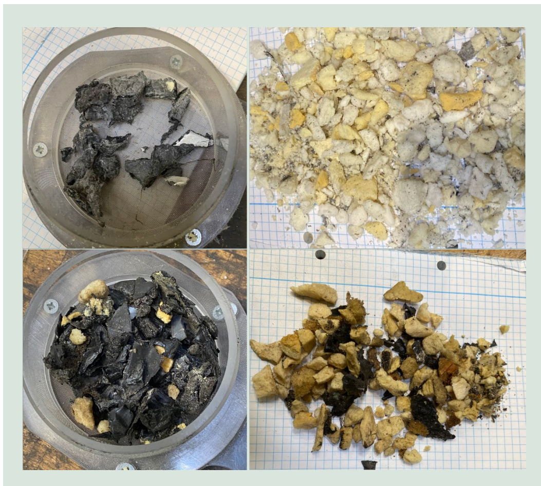
FIGUR 7. Vindsigtningsforsøg i laboratorieopstilling (øverst tv: separeret tung fraktion fra rør uden mellemlag, øverst th: separeret let fraktion (skum) fra rør uden mellemlag, nederst tv: separeret tung fraktion fra rør med mellemlag, nederst th: separeret let fraktion (skumholdig) fra rør med mellemlag).
