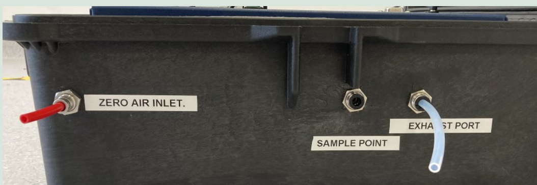
FIGUR 14. Ind og udgange fra kassen til prøveluft (sample), nul-luft og udluft (exhaust).
