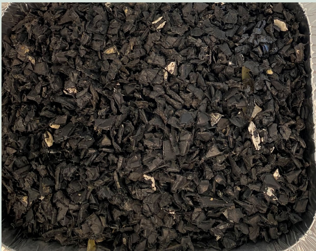
FIGUR 49. Sorteret, vasket densitetssorteret og tørret HDPE fra rør med CFC.
