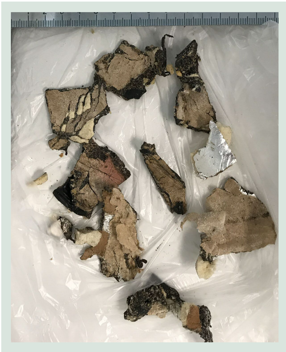
FIGUR 91. Pap, metalfolie, bitumen og skum.
