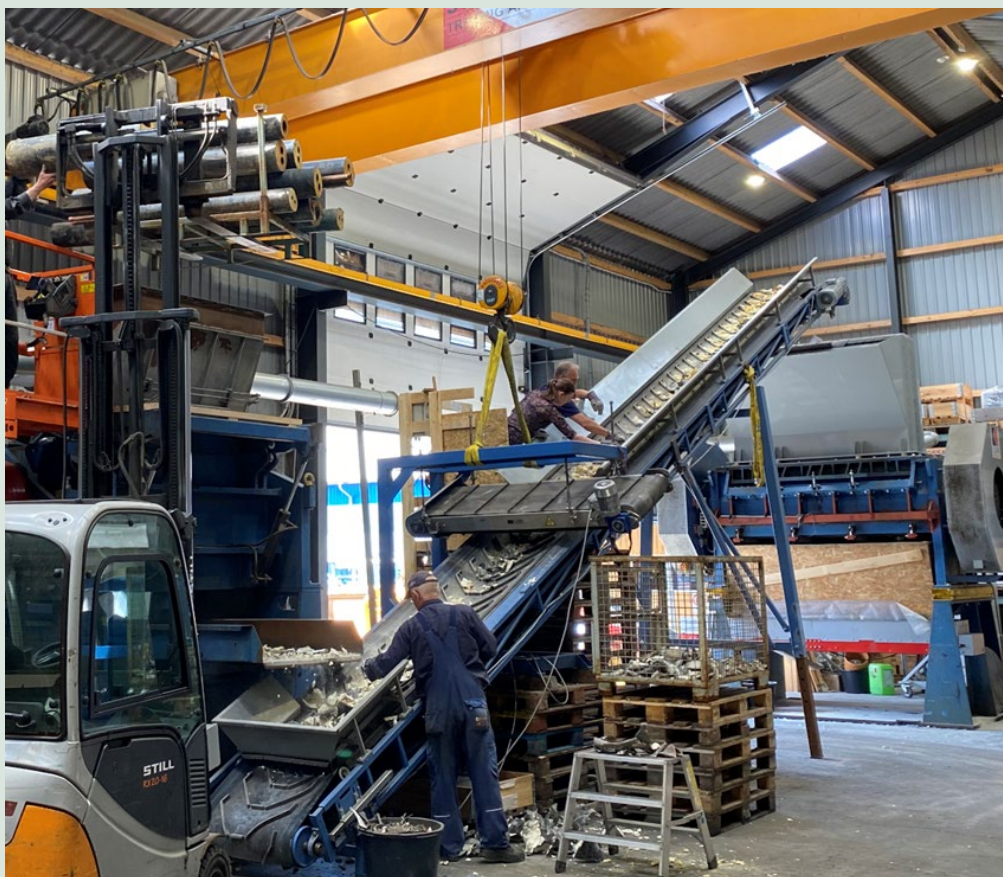
FIGUR 32. Neddeling og separation af jern.
