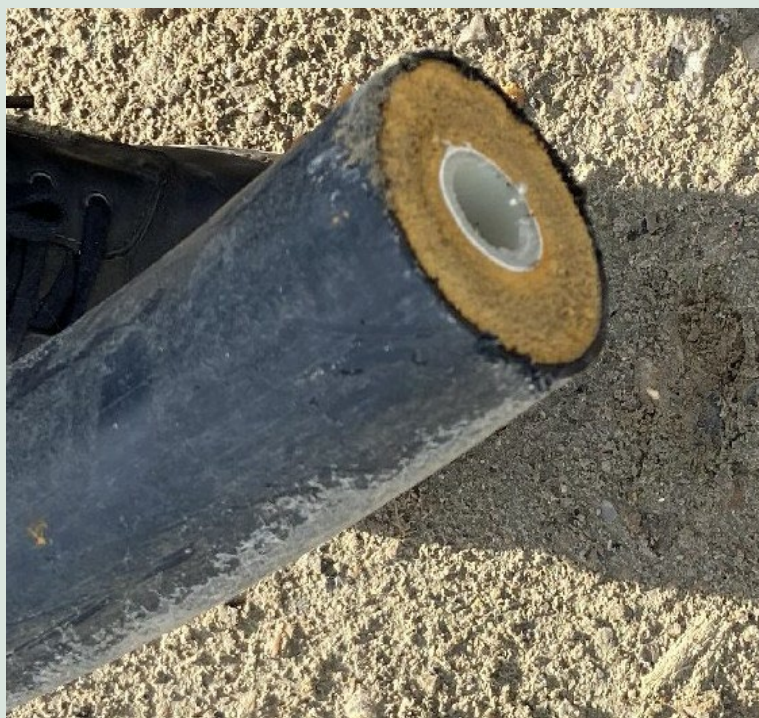
FIGUR 3. Fjernvarmerør med PEX-medierør.
