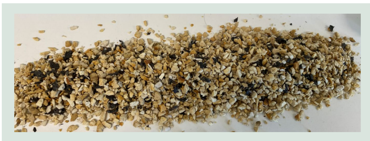
FIGUR 41. Skum fra rør med CFC, 1 gang vindsigtning inden sortering.
