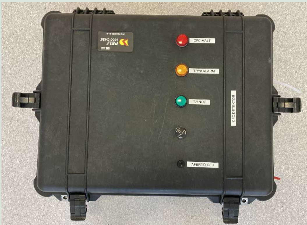
FIGUR 13. Vandtæt kasse med simple funktioner installeret ved lys- og lydgivere yderst på kassen.
