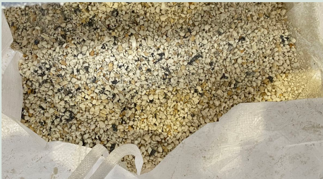
FIGUR 36. Skum fra materiale uden CFC (1 gang vindsigtning).
