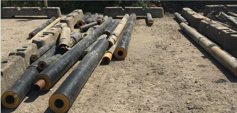
FIGUR 22. Type 2: Rør uden bitumenmellemlag/andet problematisk, uden CFC.
