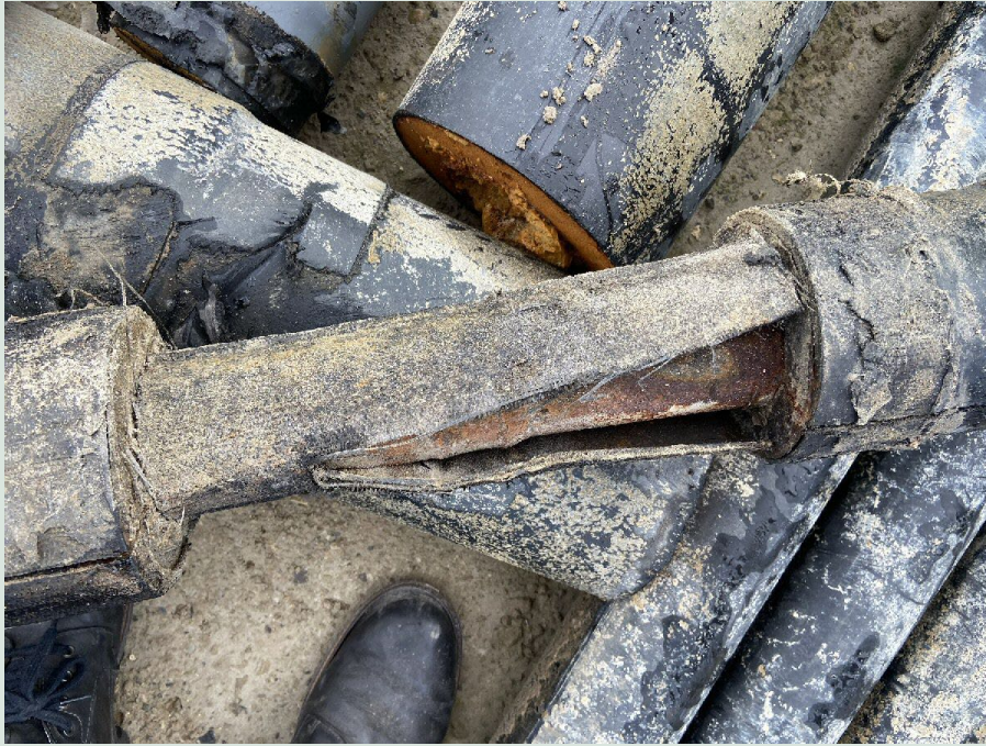
FIGUR 70. Tekstillærred (PP) med underlag af indtørret bitumen/klister (L2).
