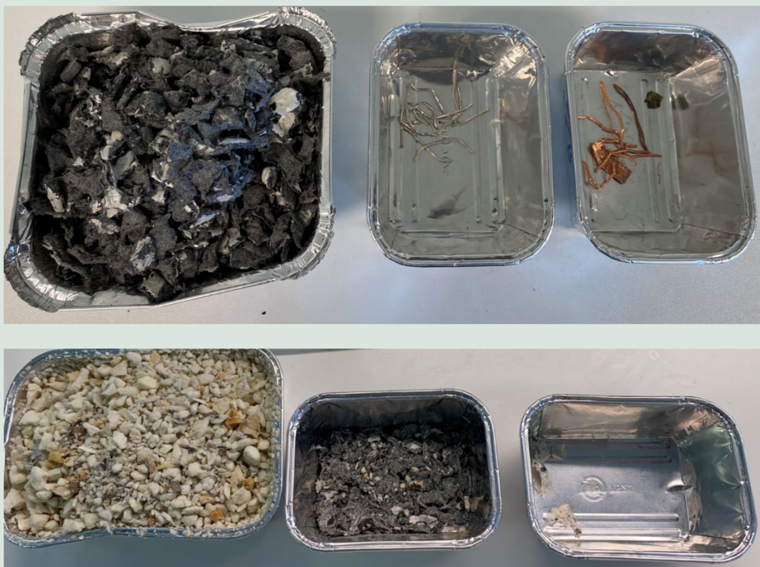
FIGUR 38. Øverst (HDPE-fraktionen 1 x vindsigtning): HDPE, fortinnet tråd, kobber. Nederst: (skum-fraktionen 1 x vindsigtning): PUR-skum, HDPE, folie.
