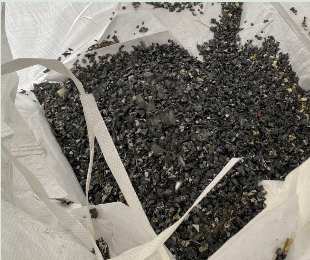
FIGUR 35. HDPE fra materiale uden CFC.
