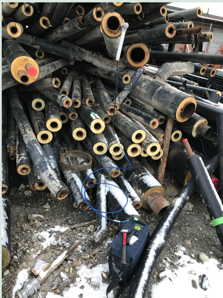
FIGUR 12. Test af CFC-sensoren hos Dan Jord januar 2021.
