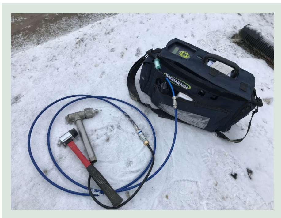
FIGUR 11. Komponenterne af CFC-sensoren hos Dan Jord, januar 2021. Der er påsat længere slange og skiftet til en hammerudgave af proben.
