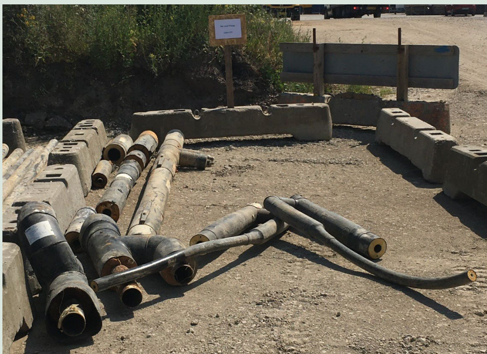
FIGUR 24. Type 4: Rør med bitumenmellemlag/andet problematisk, uden CFC.
