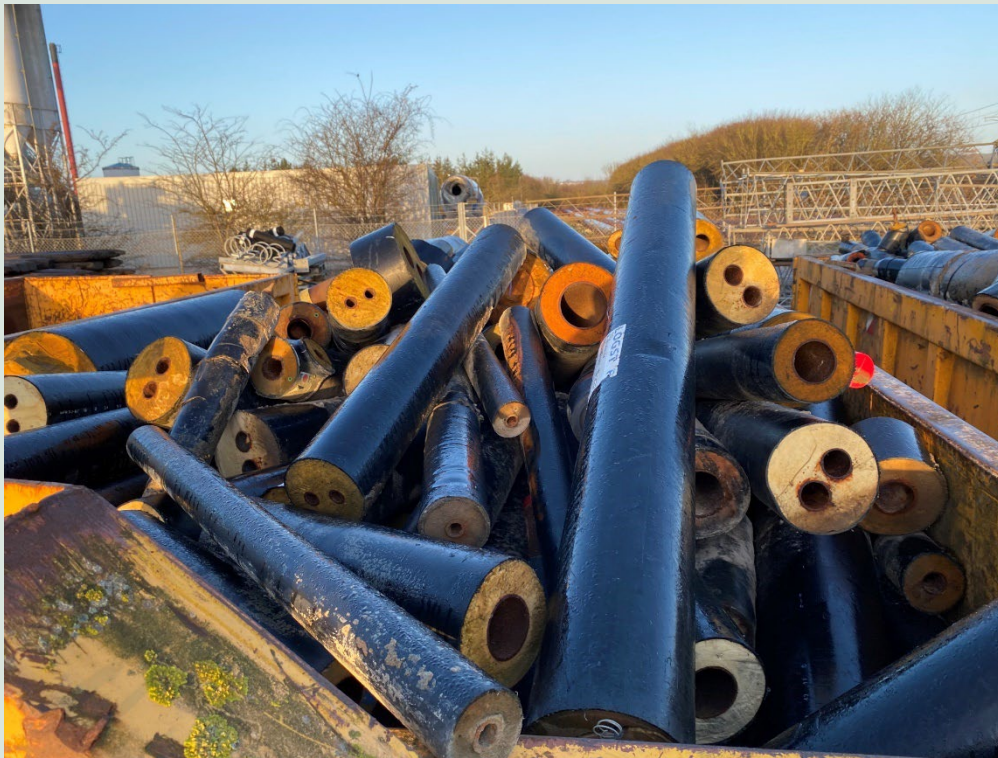
FIGUR 27. Type 2: Forbehandlede rør, uden mellemlag uden CFC.
