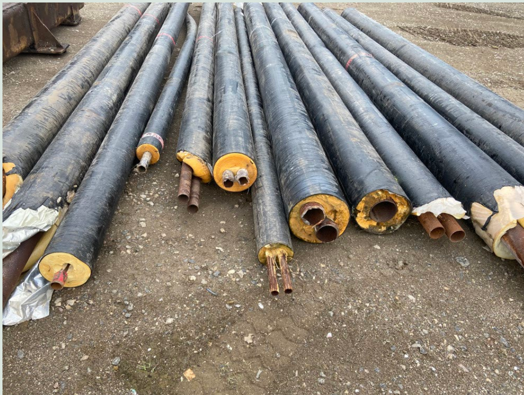
FIGUR 8. Fjernvarmerør til neddelingsforsøg.
