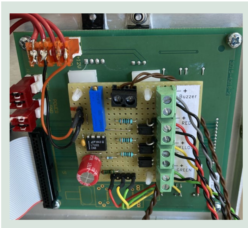
FIGUR 15. Print til styring af signalgivere. De fem ledningspar styrer: Tryk-knap (OK), Fejl, Tændt, CFC fundet, buzzer.
