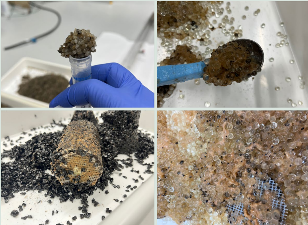
FIGUR 7. Til venstre ses det, hvorledes hhv. sand (øverst) og antracit (nederst) var klisteret sammen af EPS. Til højre ses det, hvorledes glaskuglerne var omgivet af EPS (øverst test 3, nederst test 4).
