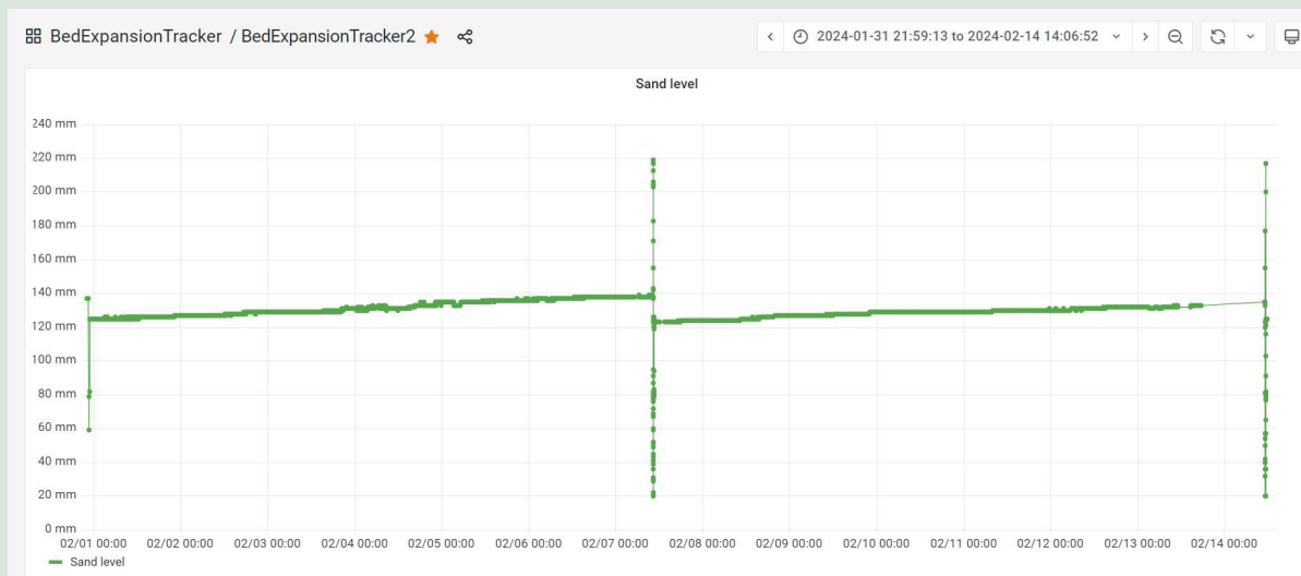
FIGUR 14. Målinger af filtermediehøjden over to gangtider på Tolne Vandværk. Målingerne viser, at afstanden til overfladen stiger over gangtiden, hvilket tyder på, at filtermaterialet sætter sig i løbet af gangtiden.
