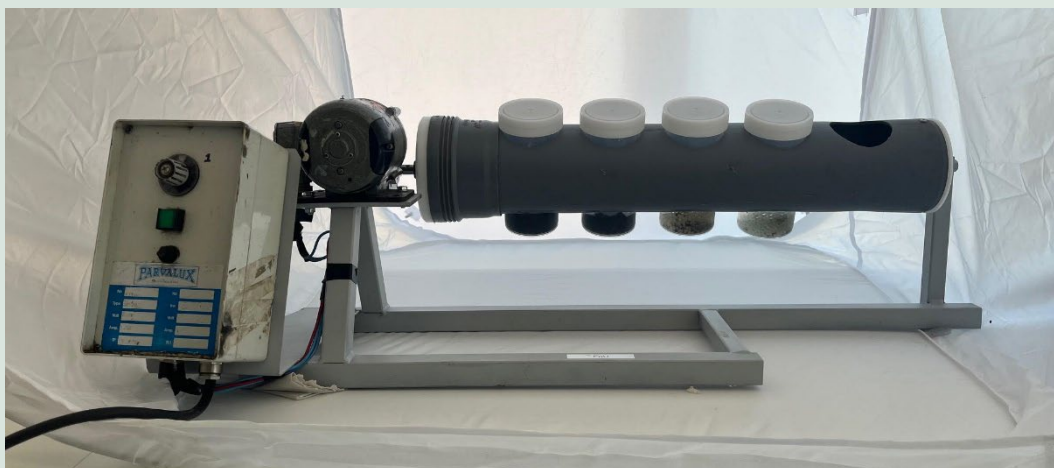
FIGUR 6. Opstilling, hvor en beholder med filtermateriale og vand roteres for at slide biofilm af.
