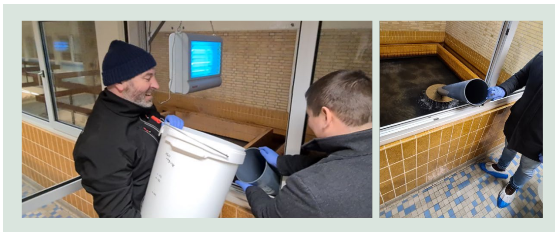
FIGUR 9. Fuldskalaforøg med FHT på Tolne Vandværk. En saltopløsning doseres i toppen af filteret og saltets passage gennem filteret måles ved filterets afgang.
