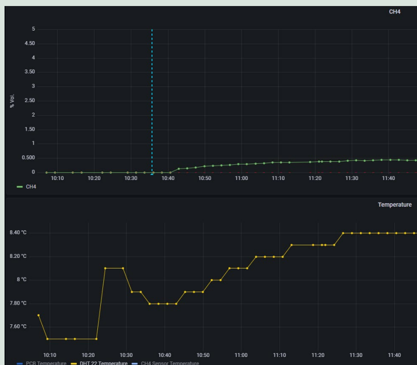
FIGUR 17. Grafen viser en methanmåling på råvandet fra Tolne vandværk udført med Online Methan Trackeren.
