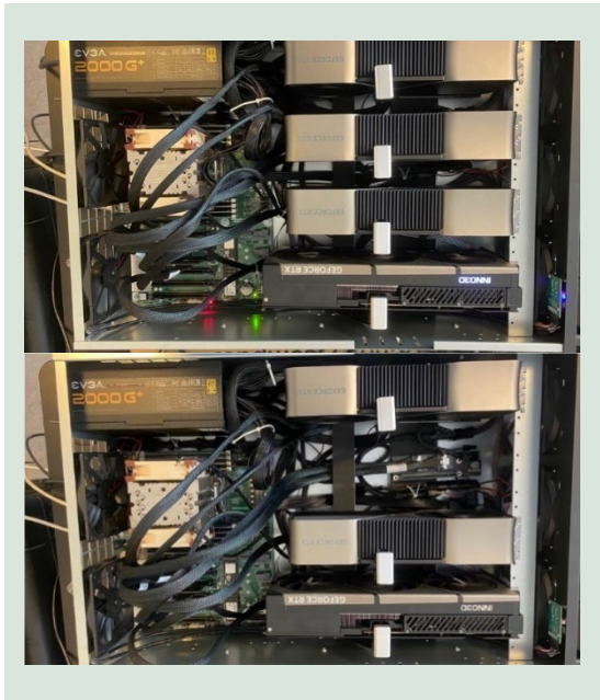
FIGUR 18. Multi-GPU-maskinen (øverst) og Multi-GPU-maskinen hvor den ene GPU er fjernet, så man kan se det bagvedliggende PCIe riser kort (nederst).
