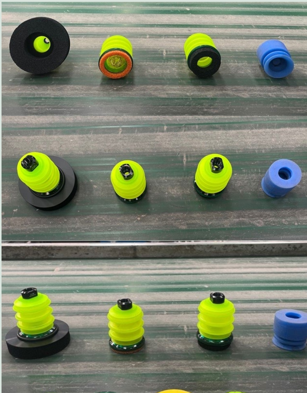
FIGUR 54. Oversigt over de fire testede sugekopper på sorteringsrobotten ved ARC.
