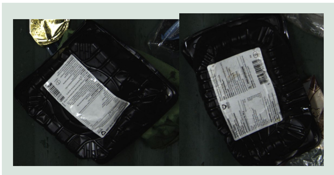
FIGUR 28. En fejlklassificeret HiltonFoods1 bakke med bunden opad til venstre og en korrekt detekteret FaerchDanishCrown bakke med bunden opad til højre.
