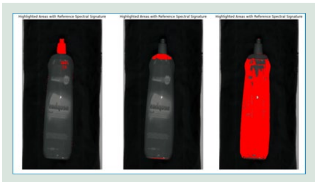
FIGUR 37. Greyscale visualisering af emne med 3 typer plastik og Markering af pixels med spektrum tilsvarende plastiktypen A) PP B) HDPE C) LDPE.
