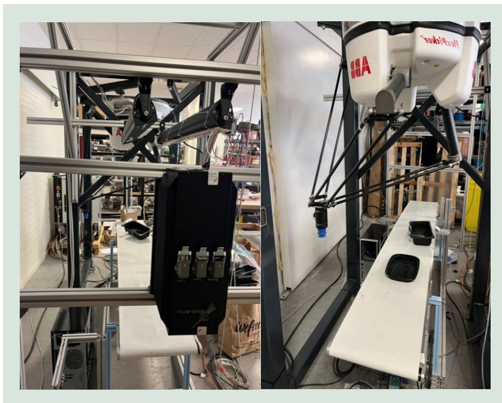
FIGUR 34. Opsætning af spektral-kamera og sorteringsrobot i IHFood Lab.
