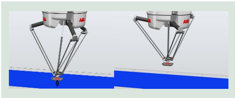
FIGUR 47. Illustration af Flexpicker opererer under en opsamlings- og sorteringsproces.
