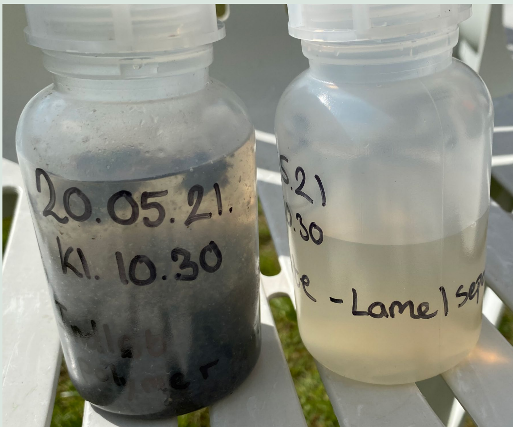
FIGUR 41. Eksempel på input fra hydrolysetank til lamelseparator (tv) og det producerede rejeckt-vand (th).
