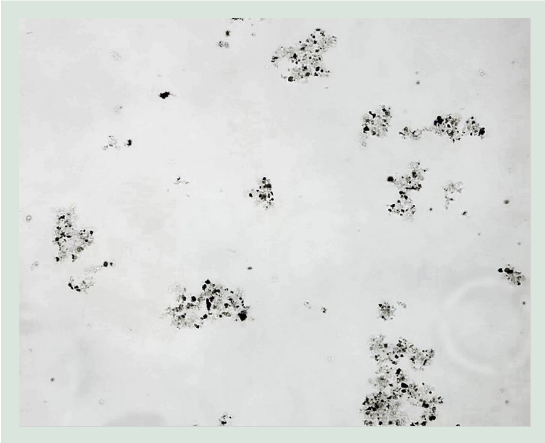
FIGUR 43. Fældningsbillede for prøve fra forsøg 3 efter 30 min. De største partikler på billedet er ca. 10 \mu\text{m} .
