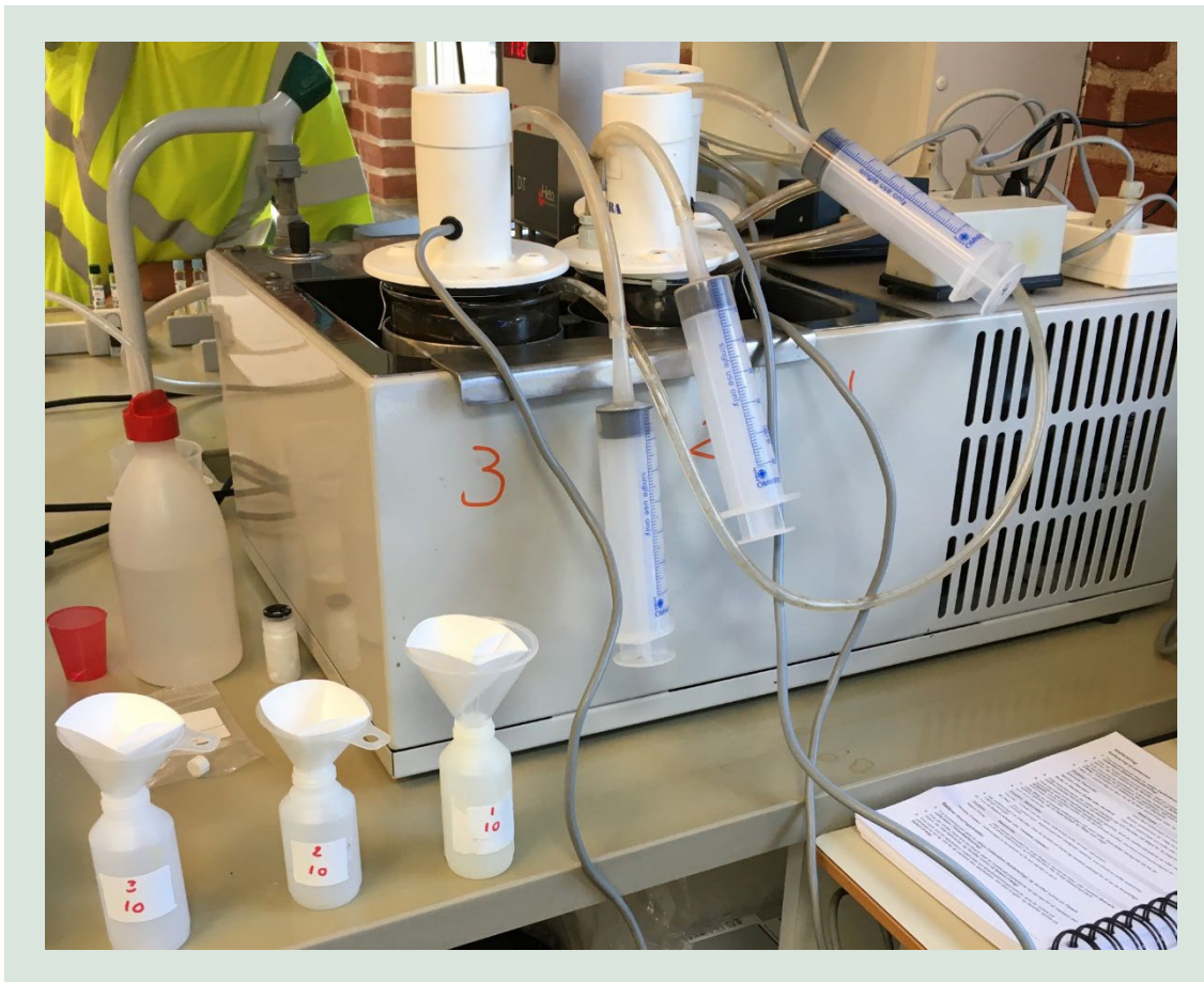
FIGUR 20. Opstilling til undersøgelse af bio-P-akkumulering aerobt/anaerobt.
