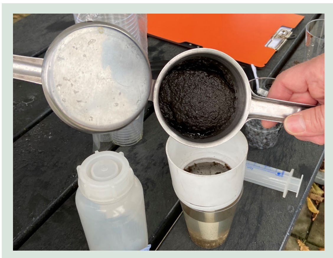
FIGUR 26. Dræning/filtrering af væske fra flokkuleret slam med simpel håndpresse.
