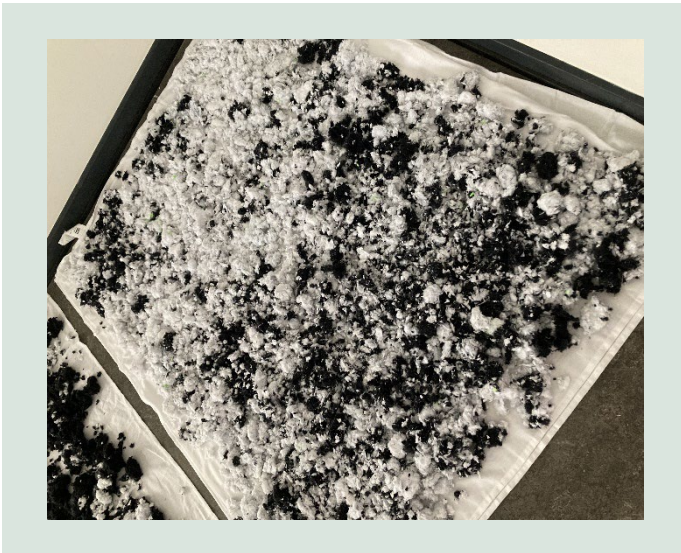
FIGUR 13. Her ses at de to farver tekstil der er testet er blandet grundigt, hvilket validerer at der er tilstrækkelig turbulentens i bunden af kolonnen og dermed god omrøring.
