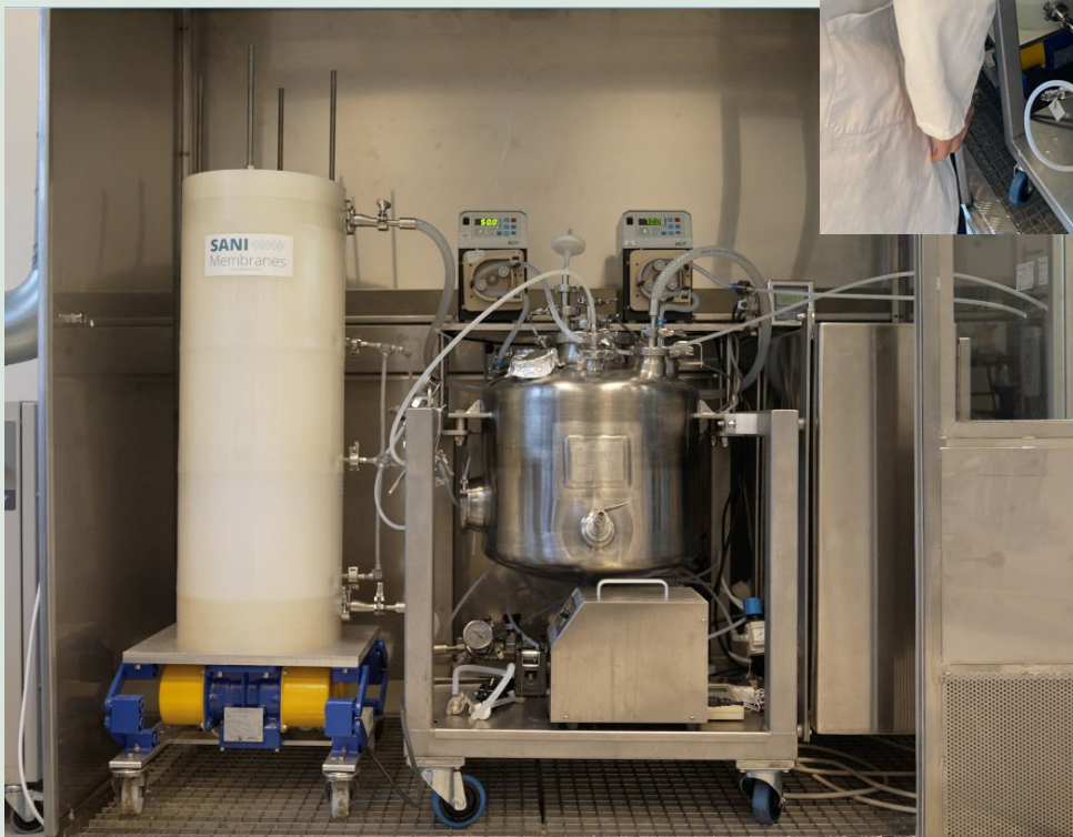
FIGUR 4-6. Vask ved diafiltrering i Vibro-filtreringsanlæg 0,35 m 2 i laboratoriet øverst til venstre og den opskalerede filtreringsopstilling 7,5 m 2 nederst og til højre.
