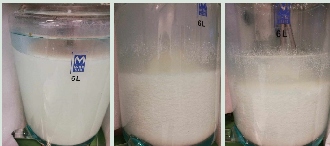
FIGUR 3-3. Ændring i karakteristika af råpolymer i syntese suspension ved stigende ethanol tilsætning.
