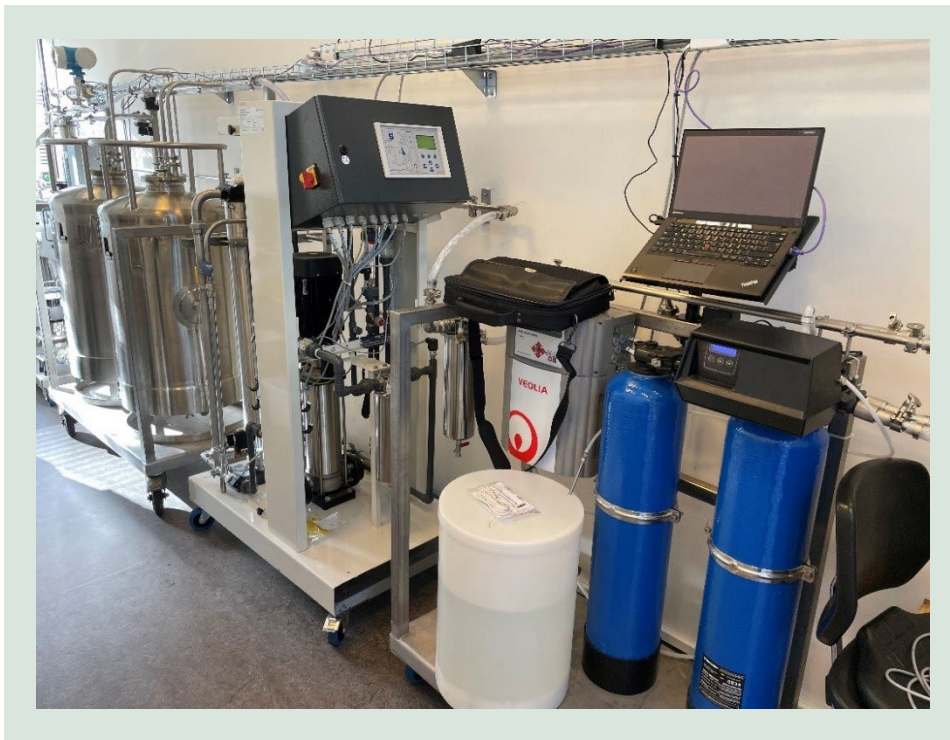
FIGUR 7-2. Centralt anlæg til produktion af Purified Water. Figuren viser den indledende fjernelse af hårdhed og det efterfølgende RO-trin til afsaltning – reduktion i TOC og ledningsevne. Til venstre de to lagertanke med Purified Water.
