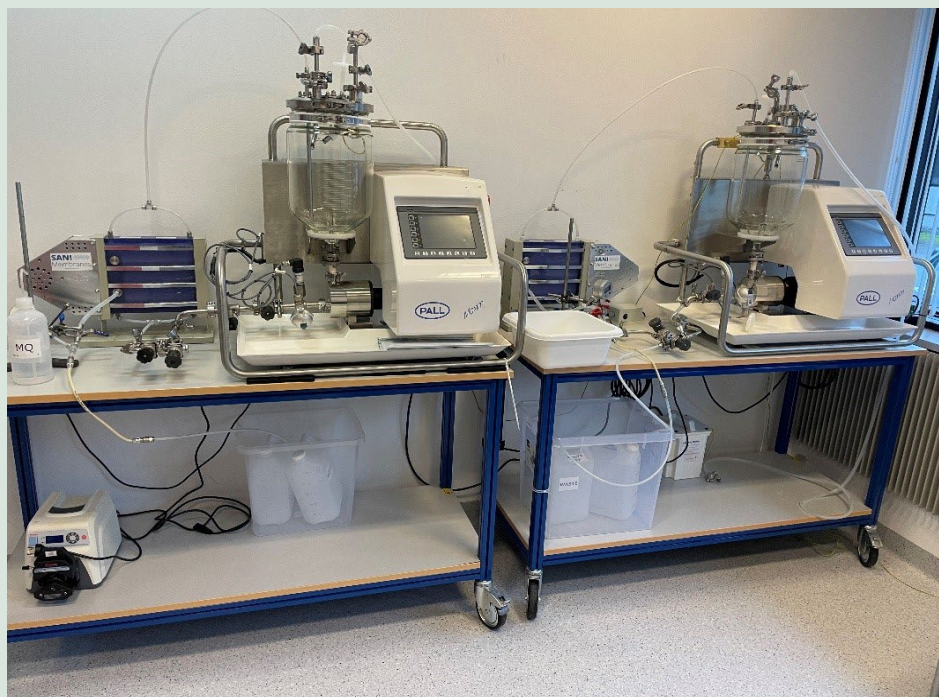
FIGUR 5-1. SANI-Membranes Vibro®-Lab3500 enheder anvendt til dia-vask af neddelte polymer med Purified Water.
