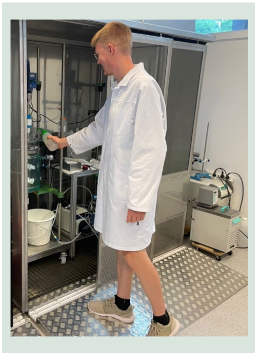
FIGUR 3-1. Opskaleret synteseproces til produktion af Phelimin i specialdesignet proceskabinet.
