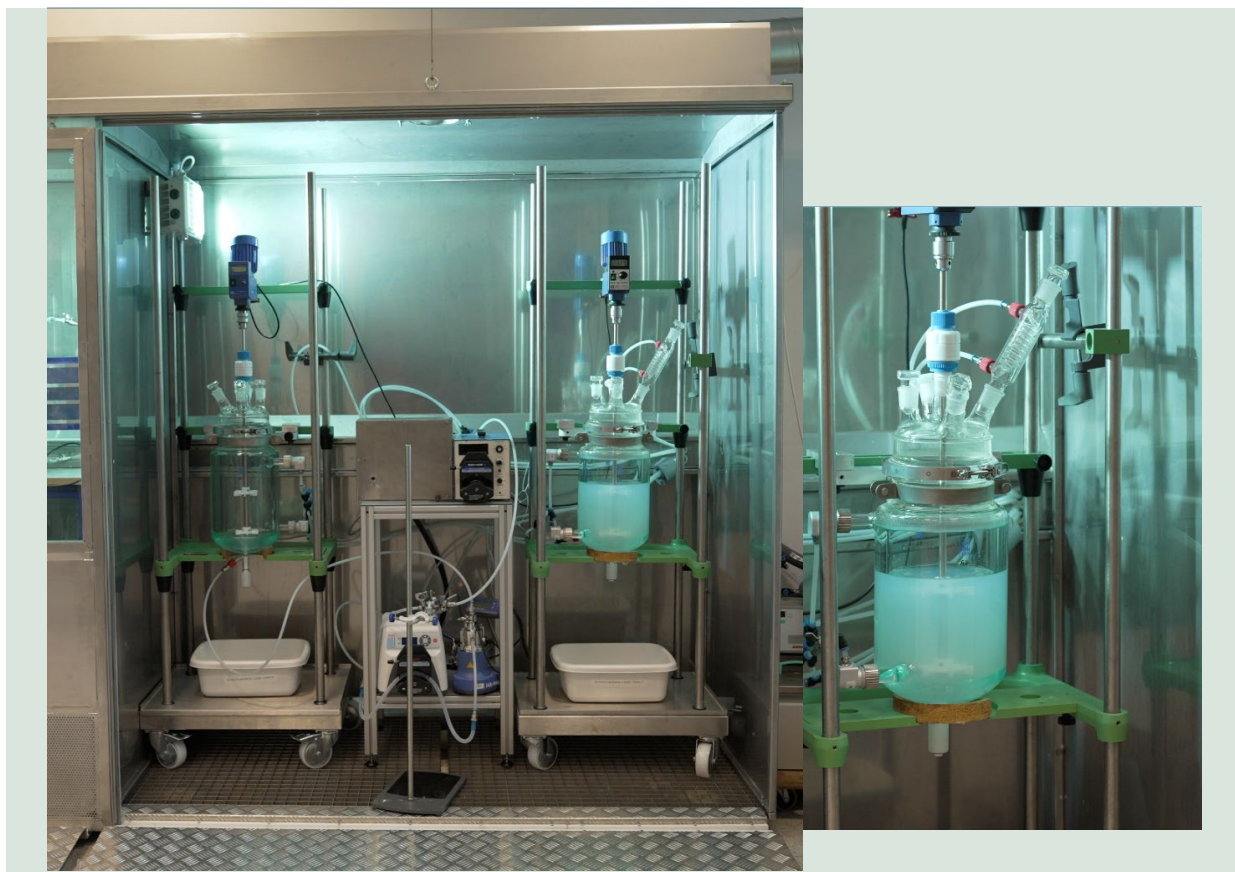
FIGUR 3-2. Opskaleret opstilling for synteseprocessen til batchstørrelse 360 g råpolymer samt reaktor til syntese af råpolymer (indsat foto).
