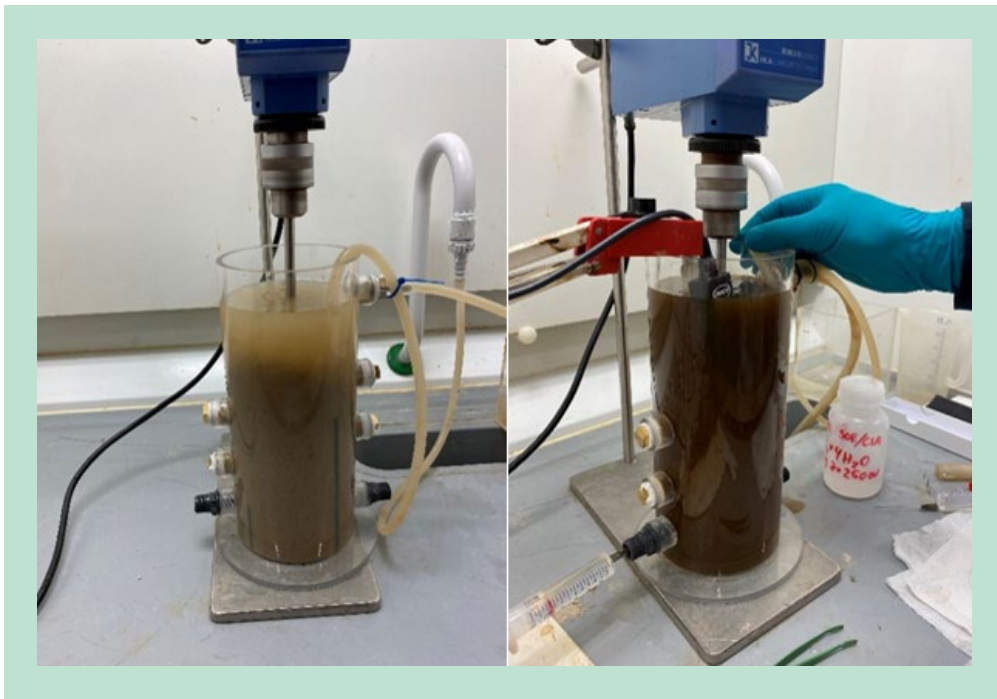
FIGUR 9. Test af reaktor med vand og sand til venstre og granulatfremstilling med manuel dosering, Batch 1 til højre.
