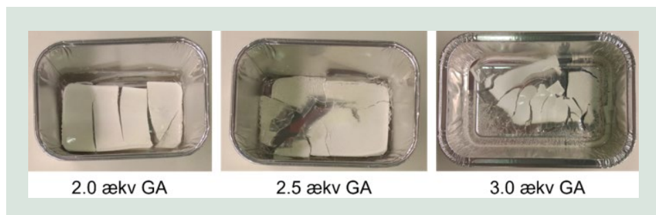
FIGUR 25. Hærdning af MGA (pH = 4) med forskellige mængder GA ved stuetemperatur.
