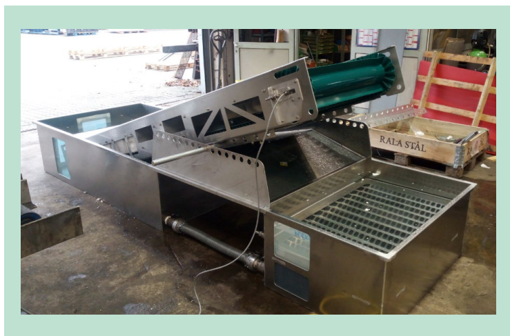
FIGUR 6. Test af bælteskimmer hos leverandøren – Oktober 2021.
