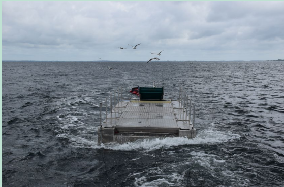
FIGUR 18. Bugsering til indsatsområde. Desmi flydespærring som drivanker.
