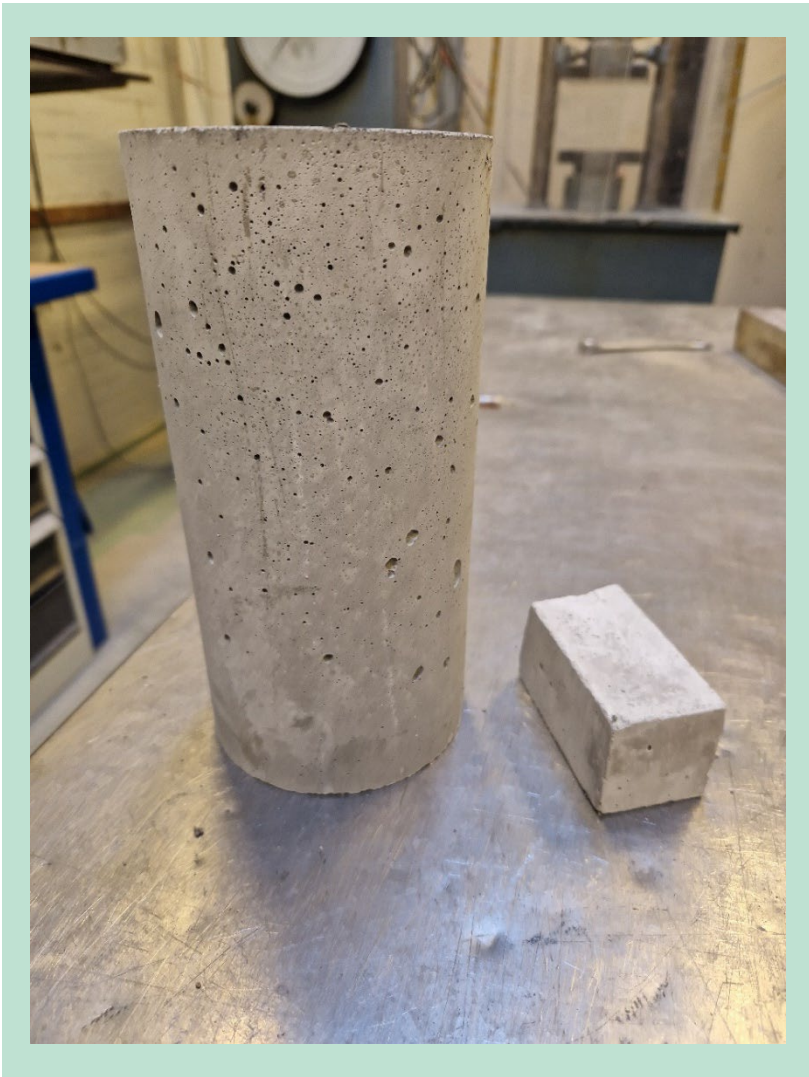
FIGUR 14. Betoncylinder (ø100 mm) til venstre og 40 mm mørtelterning til højre.
