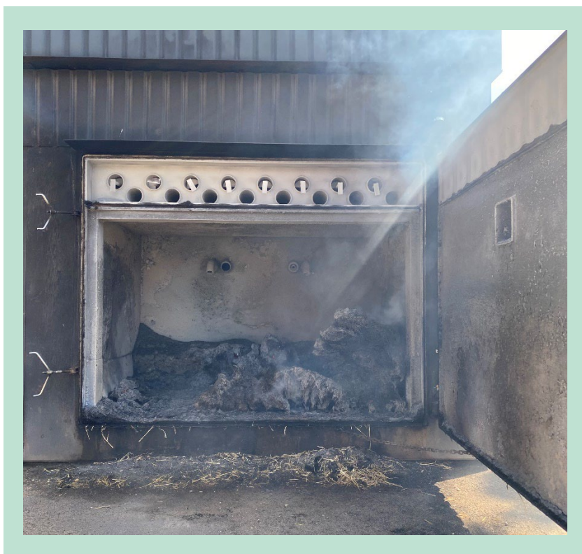
FIGUR 3. Brændkammer åbnet før forbrændingen er afsluttet viser bundaske (hvidt/gråt) samt ikke forbrændt organisk materiale ("restkoks", sort).
