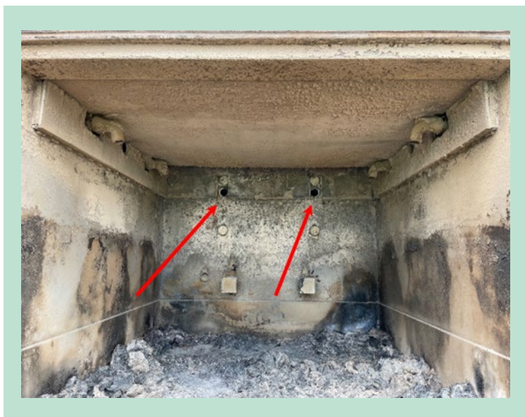
FIGUR 26. Forsøgsconfiguration: Sekundærluftdyser i bagvæggen er åbnet.
