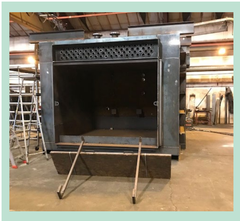
FIGUR 22. Forsøgsbrændkammer under opbygning: forside.
