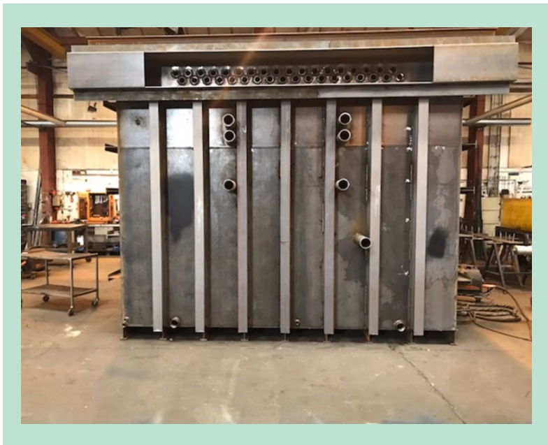
FIGUR 23. Forsøgsbrændkammer under opbygning: bagside.
