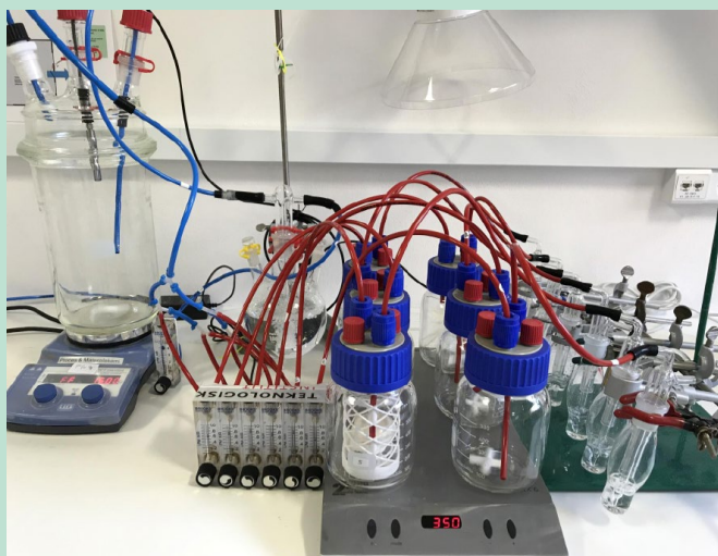
FIGUR 4. Forsøgsopstilling til test af frigivelse af formaldehyd hos Teknologisk Institut.
