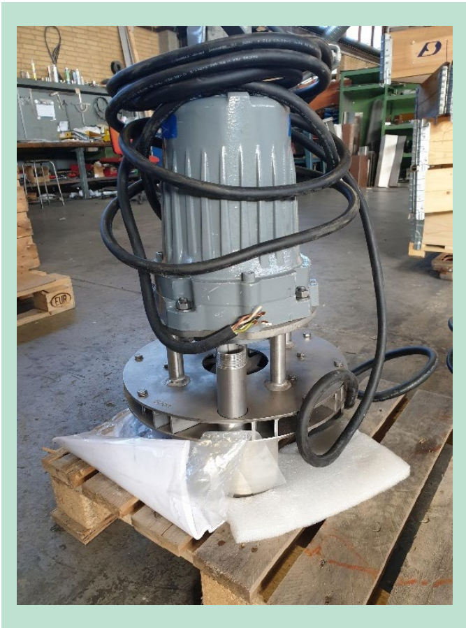
FIGUR 3. Beluftningspumpe til anvendelse i blokmediereaktor (OptiGas-koncept)
