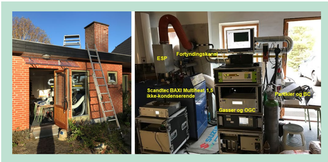
FIGUR 7. Forsøgsopstilling hos en privat bruger med ESP-filter monteret på toppen af kedlen (Scandtec BAXI Multiheat 1,5). En mængde af røggassen ekstraheres i fortyndingskanalen, hvor røggassen blev fortyndet med baggrundsluft. Partikelantalskoncentration, partikelmassekoncentration og BC blev målt fra fortyndingskanalen, mens andre parametre (CO, CO 2 , O 2 , NO x , støv) blev målt ufortyndet.
