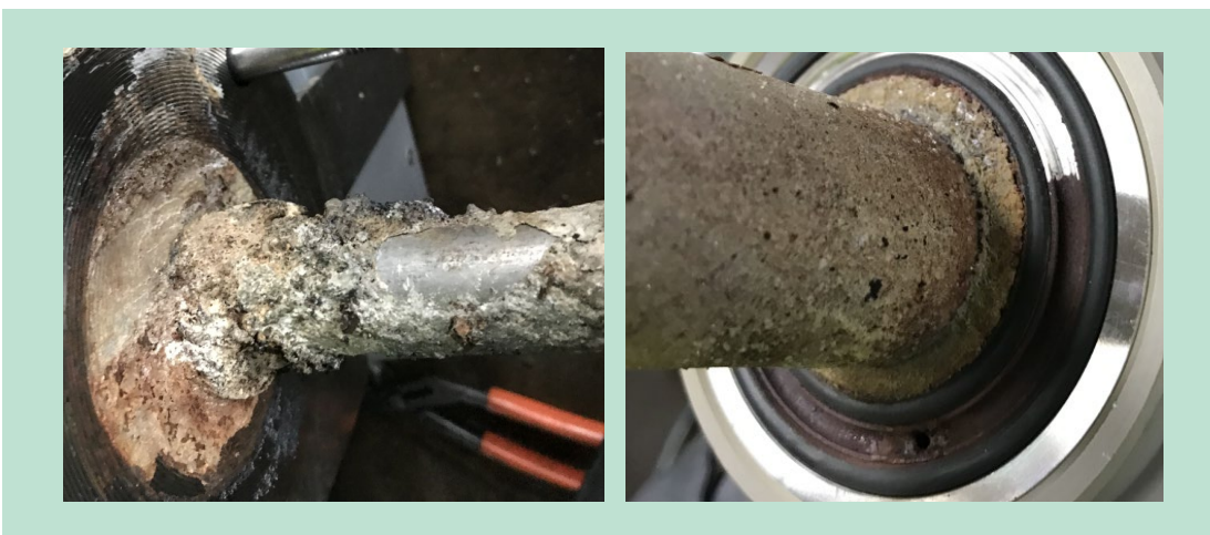
FIGUR 12. Indstiksør og keramisk filter efter få ugers test på DFDS Crown Seaways.
