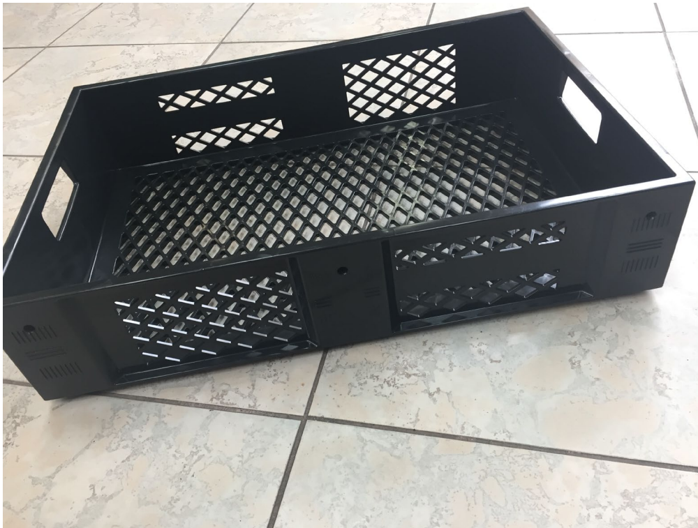
BILLEDE 3. Brødkasse prototype DK 173, 50% rHDPE OceanIX og 50% kværnet plast fra re-turkasser
