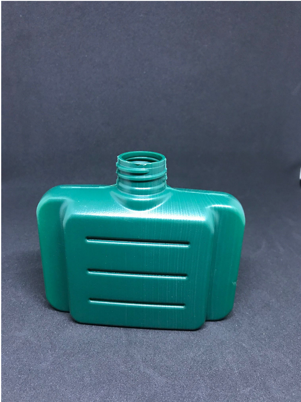
BILLEDE 5. 250 ml. testflaske i 100% OceanIX rHDPE
