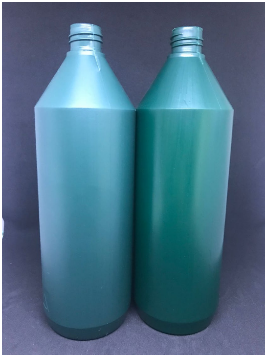
BILLEDE 4. Blæsestøbning af flaske i 100% virgin (tv.) og 100% Oceanix rHDPE (th.)
