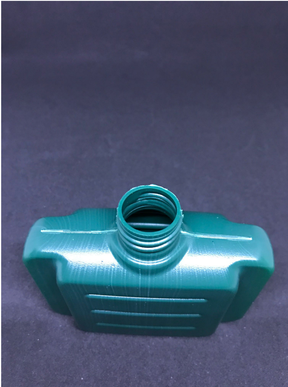
BILLEDE 6. 250 ml. testflaske i 100% OceanIX rHDPE
