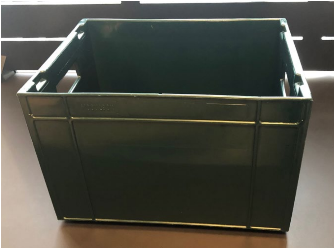
BILLEDE 1. Kasse med 65% OceanIX rHDPE 0507 og 35% Sabic HDPE MFI 30 - blandet direkte på sprøjtestøbemaskinen
