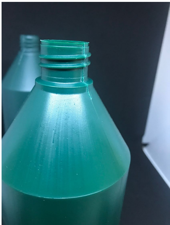
BILLEDE 5. Detalje af teststøbning i 100% OceanIX rHDPE. Gevindkanter fremstår skarpt og struktur i overflade lidt grovere.
