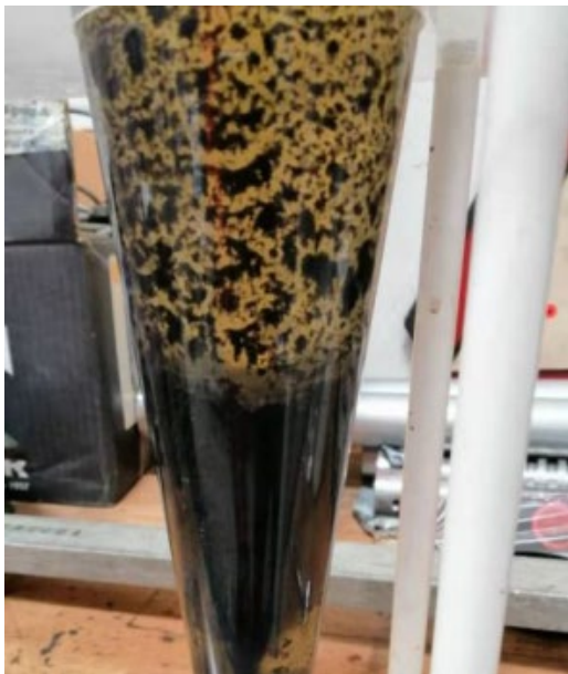
FIGUR 9. Test af slam volume index, Procesvand fra vaskeanlæg, tilsat polymer
