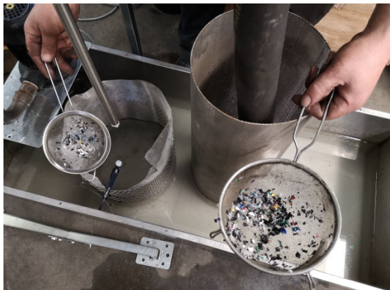
FIGUR 3. Test separation på testopstilling hos Belki Teknik ApS. Stor si: PET. Lille si: PP, PE.
