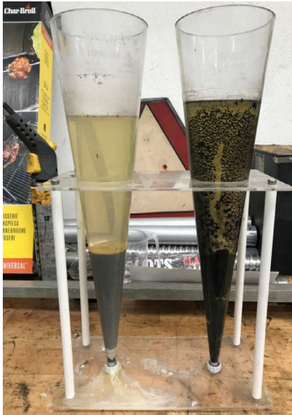
FIGUR 8. Test af slam volume index, Procesvand fra vaskeanlæg.
