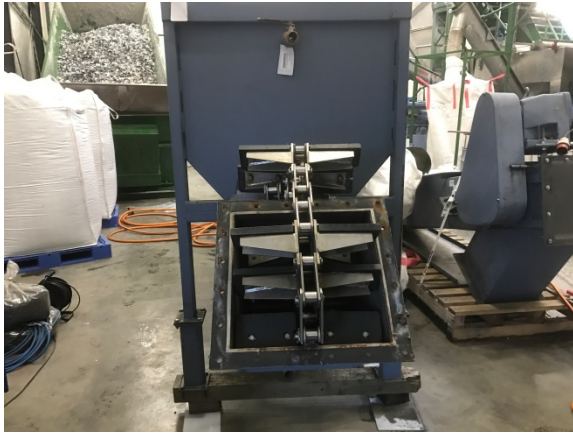
FIGUR 1. Flyde/sænkekar. Kædetransportør i aftræk, som transporterer synkefraktionen.
