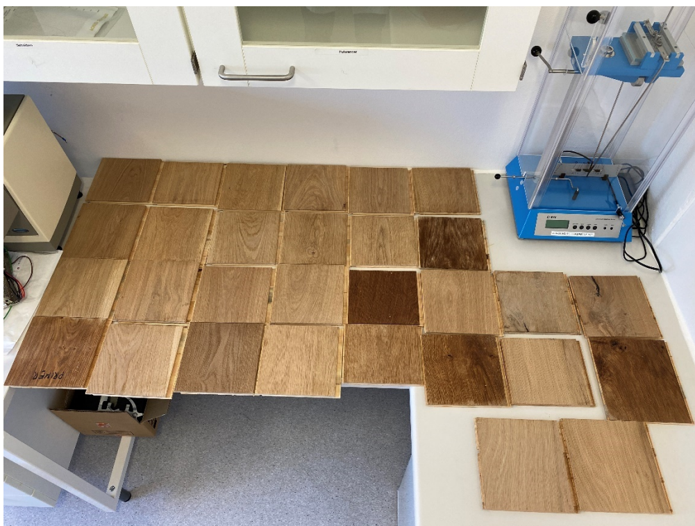
FIGUR 19. De ulakerede prøver fra alle 30 blandinger (i rækkefølge 1 til 30 i almindelig læse- retning) klar til måling af fiberrejsning på Teknologisk Institut. Bemærk den store forskel i be- fugtning mellem prøverne.
