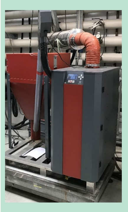
FIGUR 1. 10-kW-kedel (NBE) anvendt til træpiller-forbrændingsforsøg.
