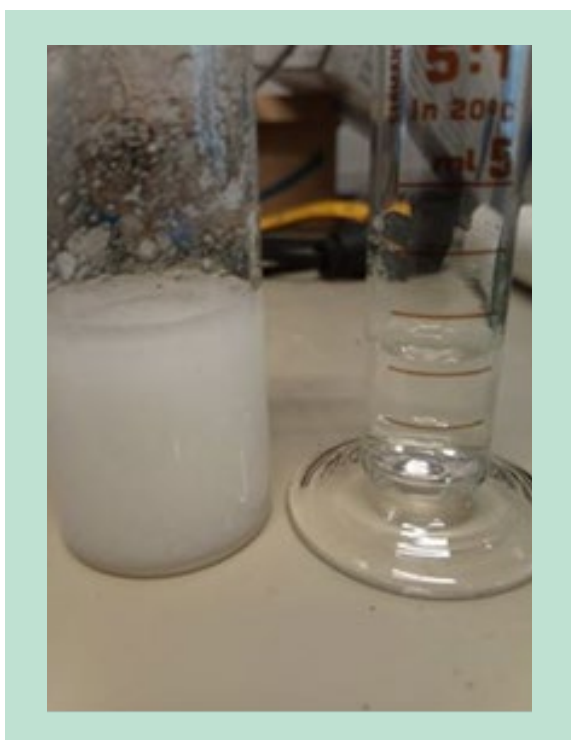
FIGUR 31. Visuelt udseende af væskefase før og efter filtrering af MP-UV/H 2 O 2 partikuleret monomeropløsning.
