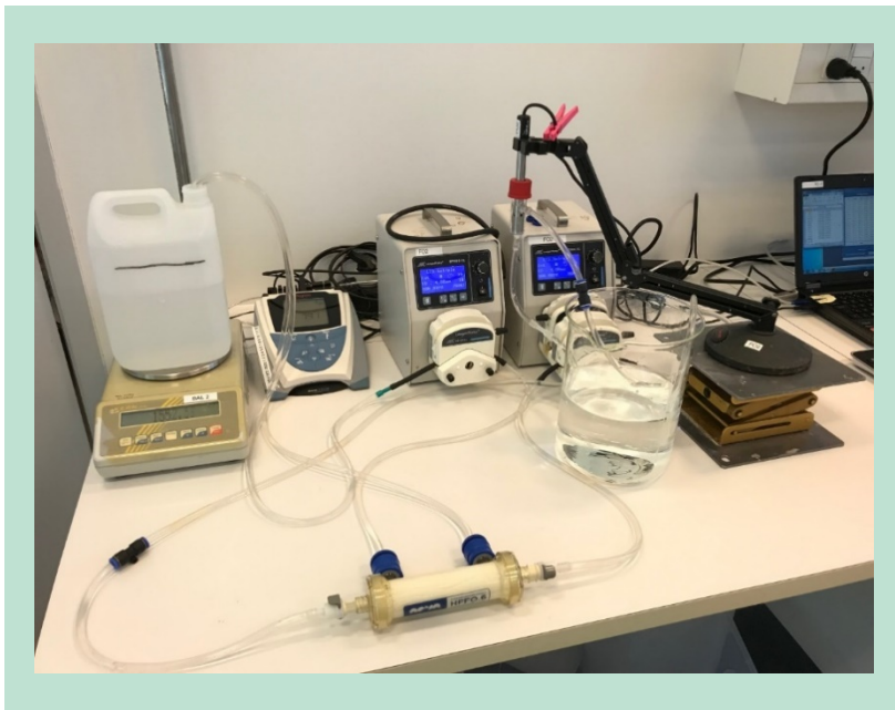
FIGUR 15. Forsøgsopstilling med test af koncept til genvinding og genbrug af RO vand ved anvendelse af Forward Osmose med koncentreret P-buffer som draw solution. Membranmodulet er en HFFO.6 membran fra AquaPorin.
