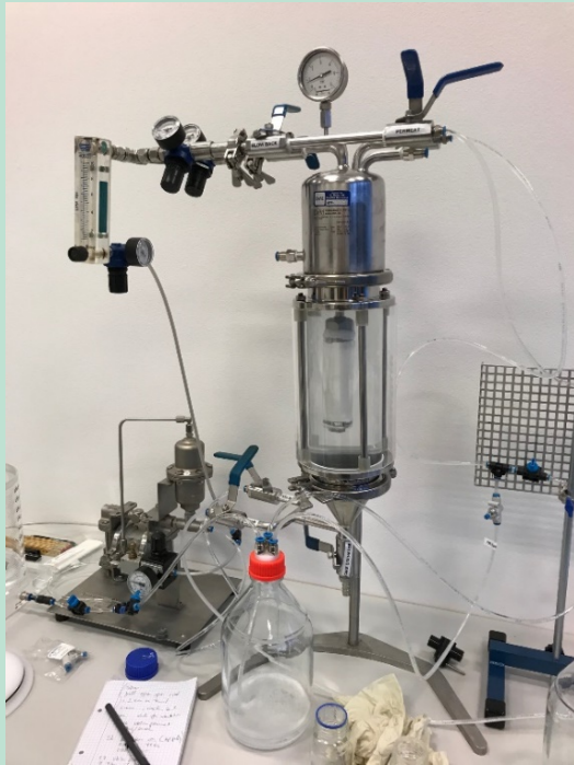
FIGUR 23. Forsøgsopstillinger benyttet til at teste muligheden for at reducere forbruget af ethanol ved introduktion af ressourcebesparende kagevask (Dr.M Candle filter til venstre) og ved cross-flow filtrering med keramisk membran (Pall testsystem til højre).
