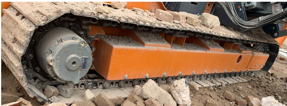
Figur 3: De konventionelle grovsorteringsanlæg er bygget på larvefødder, hvilket gør det nemmere at transportere dem rundt på pladsen
