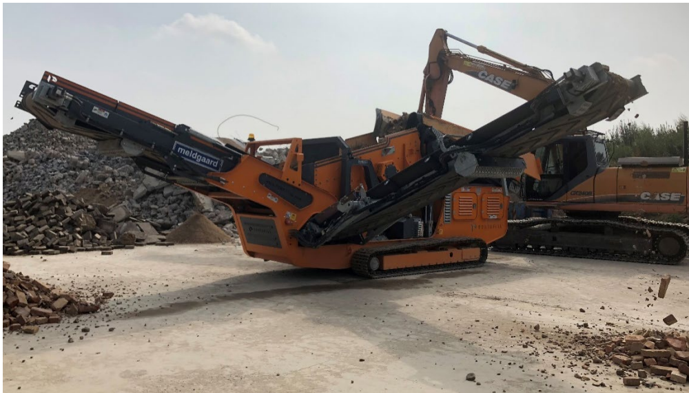
Figur 2: Test af materiale på et konventionelt Portafill grovsorteringsanlæg, der ikke er optimeret til teglfraktionen
