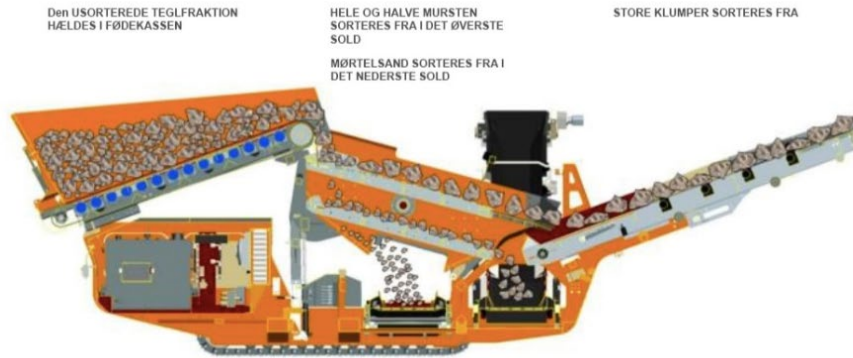
Figur 5: Processen for grovsortering af teglfraktionen
