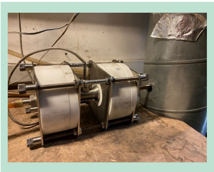
FIGUR 13. Målesektion til måling af TSP via NS 3058-metoden.
