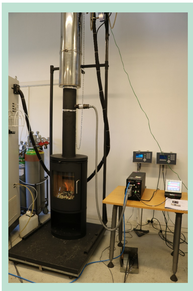
FIGUR 33. Morsø 6134 på teststand. Tilsætning af plasma til røggasser.
