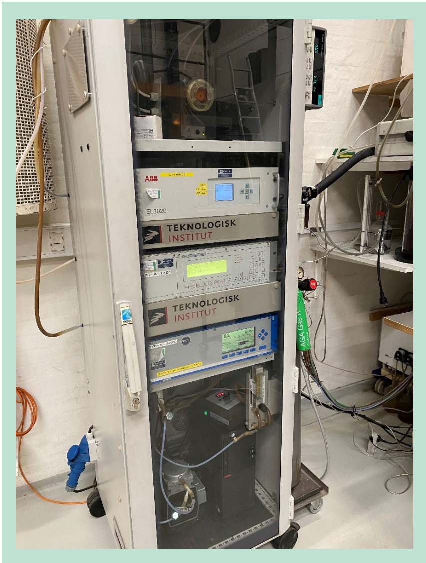
FIGUR 15. Målerack med CO/CO 2 -, OGC- og NO x -måleapparater.
