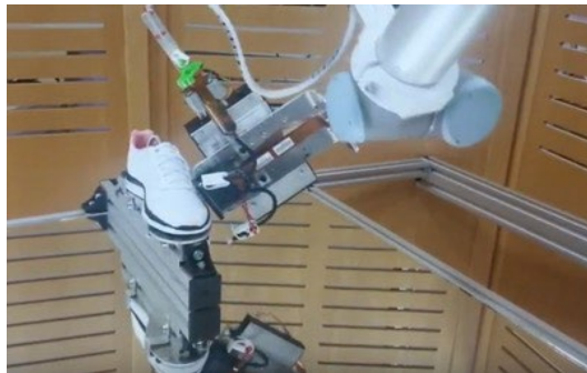
Billede 4 Eksempel på hvordan en robotarm kan arbejde med print på et produkt
