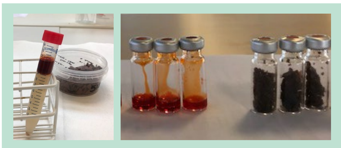
FIGUR 18. Dobbeltcentrifugeret oliefraktion samt vakuumtørret flotationsmateriale.
