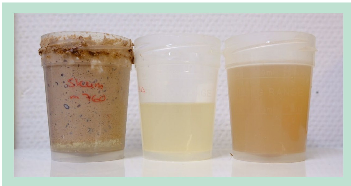
FIGUR 12. Fra venstre: floteret materiale, udløb fra flotationsanlæg, indløb til flotationsanlæg.
