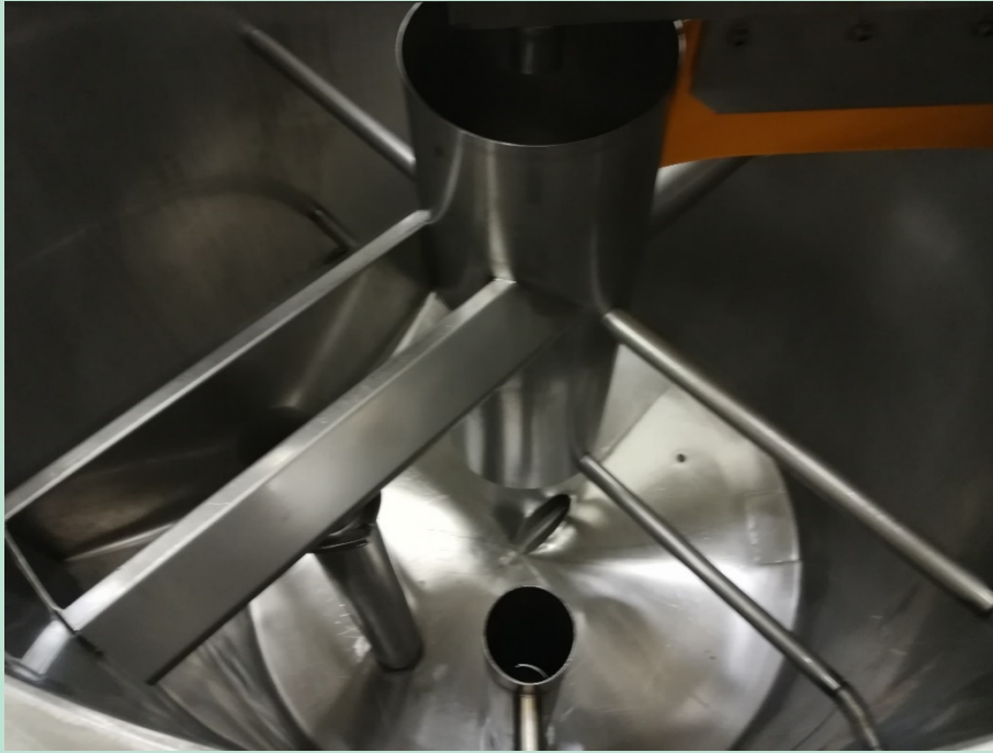
FIGUR 6. Indvendigt i tanken; hele den midterste sektion kan fjernes for optimal rengøring.
