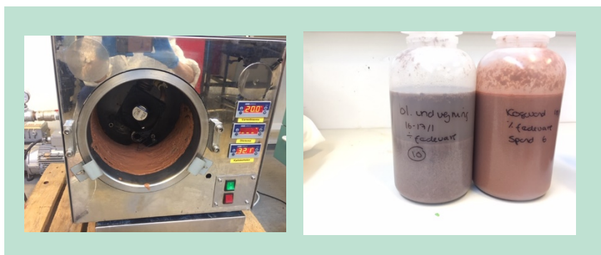
FIGUR 17. Billeder af vakuumtørre samt prøver af floteret materiale fra hhv. blandet Indvejning og kogevand.
