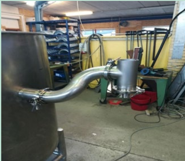
FIGUR 7. Udløbet, der er konstrueret, således at vandstanden nemt kan ændres og samtidig tillader nem rengøring.
