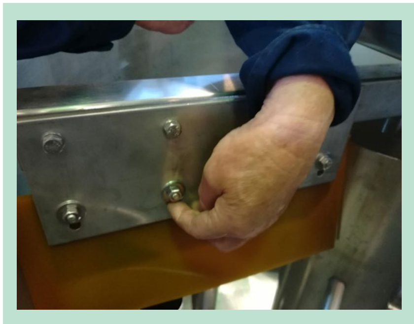
FIGUR 8. Skraberens er monteret således, at den kan afmonteres og samtidig hæves/sænkes. Der er anvendt vingemøtrikker der øger rengøringsvenligheden og hyppigheden, da de kan adskilles uden brug af værktøj.
