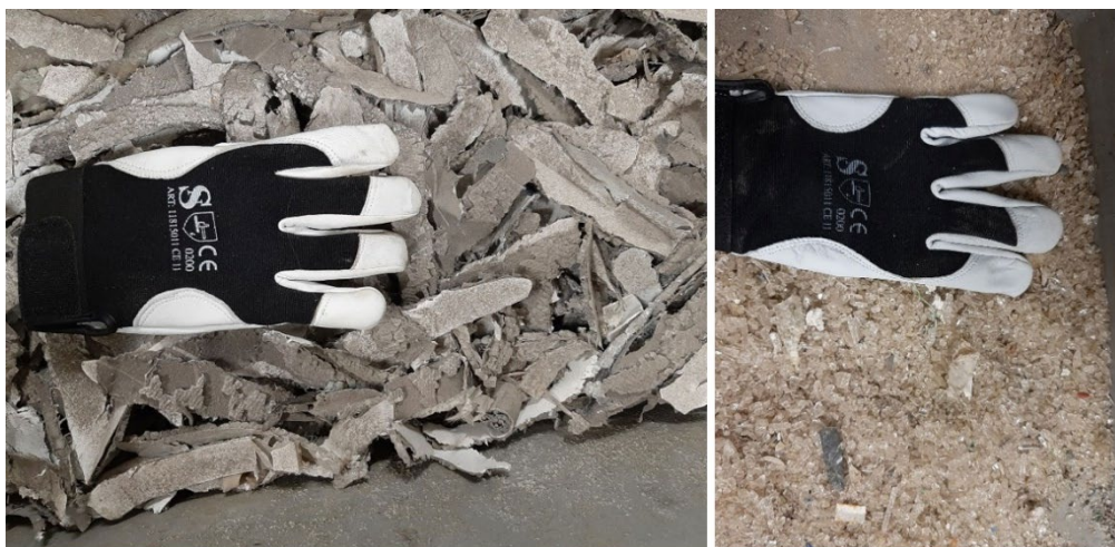
FIGUR 14. Foto af solcellepanel efter neddeling (venstre) samt de glasstykker som kan sorteres fra undervejs (højre).
