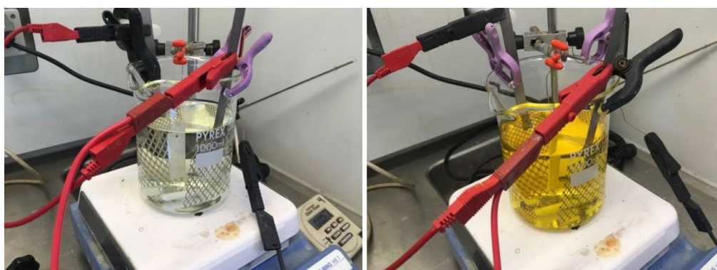
FIGUR 29. Billeder af opstilling før (venstre) og efter (højre) udfældning af sølv. Det er tydeligt at cerium-ioner oxideres fra den farveløse Ce(III) til den gule Ce(IV) form ved de uopløselige anoder under udfældningen af sølv. Anoderne består af platineret titan og har form som to fir-kantede net på hver side af katoden der sidder i midten. Sølv udfældes på katoden (den massive plade midt i bægerglasset).
