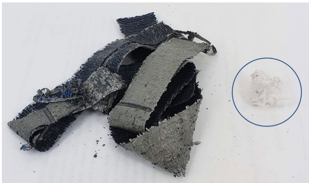
FIGUR 19. De to fraktioner som den dobbelte adskillelse af solcellepanelerne skaber. Det øverste lag EVA og resterne af solcellen vist til venstre og det nederste lag EVA til højre (næsten transparent materiale i den blå cirkel).
