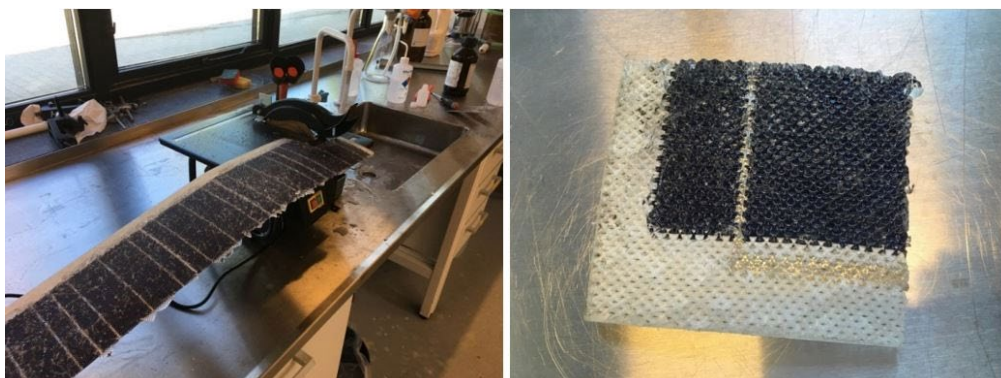
FIGUR 8. Foto af glasskæremaskinen (man kan se at glasset er knust) til venstre, og af et lille udsnit af panelet der er skåret. Glasset på denne type solcellepaneler har pyramideformede prismer i overfladen, som det også kan anes på billedet til højre.
