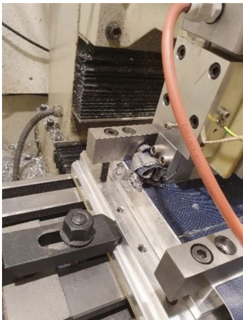
FIGUR 18. Eksempel på to-trins termomekanisk skærende adskillelse af solcellepanel. Første bearbejdning, hvor laget med solcellerne fjernes, ses til venstre. Til højre ses anden bearbejdning hvor det nederste lag EVA delvist skræbes af, og den hvide bagsidefolie kommer til syne.
