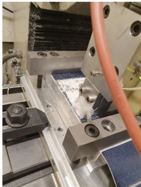
FIGUR 18. Eksempel på to-trins termomekanisk skærende adskillelse af solcellepanel. Første bearbejdning, hvor laget med solcellerne fjernes, ses til venstre. Til højre ses anden bearbejdning hvor det nederste lag EVA delvist skræbes af, og den hvide bagsidefolie kommer til syne.
