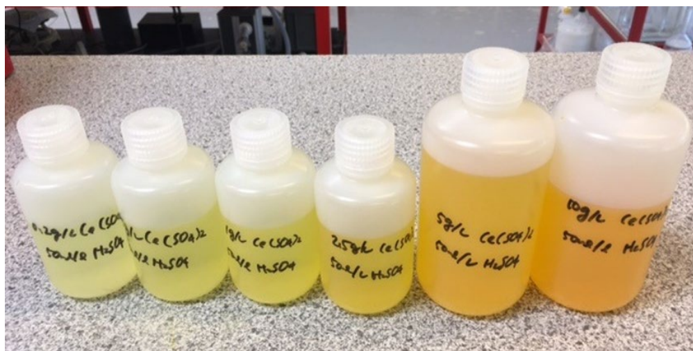
FIGUR 27. Opløsninger af \text{Ce}(\text{SO}_4)_2 og \text{H}_2\text{SO}_4 med forskellige (stigende fra venstre mod højre) koncentrationer af Ce(IV) der giver den gule farve. Ce(III) ionen er farveløs.
