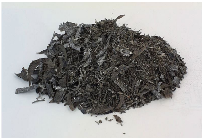
FIGUR 15. Testopstilling til termomekanisk spåntagende adskillelse af bagsidefolie. Processen er her demonstreret ved en test hvor kun det øverste lag EVA og solcellerne er fjernet, men hvor det nederste lag EVA stadig sidder på bagfolien (foto til venstre). Fotoet til højre viser EVA og solcelle rester, fjernet fra bagfolien med spåntagende bearbejdning.
