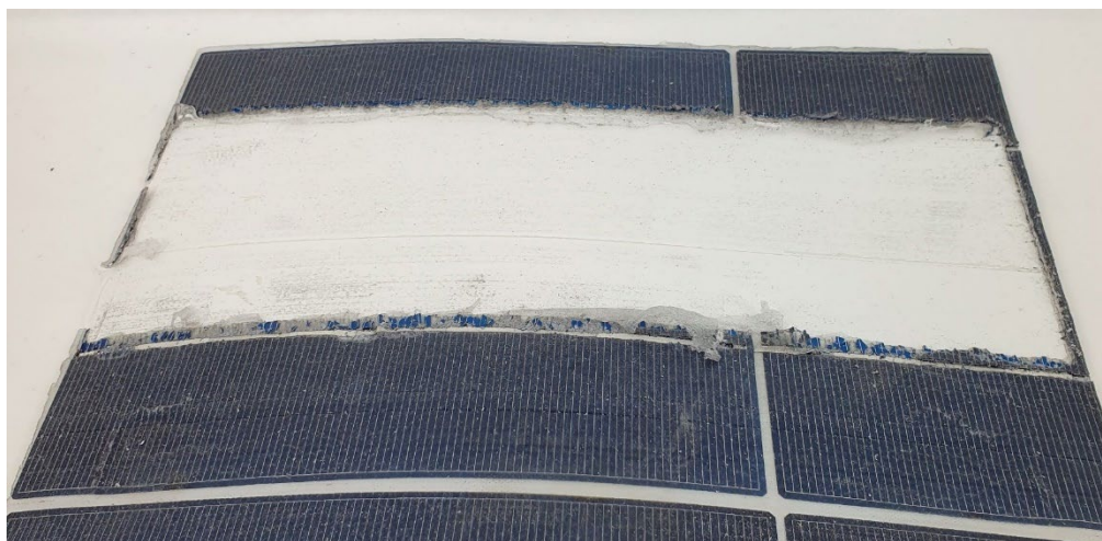
FIGUR 20. Eksempel på resultatet af adskillelsesprocessen i to trin (se ovenfor) efter at fraktionerne vist på figur 19 er fjernet. I den bane der er skrabet fri midt på billedet, kan man tydeligt se den hvide bagsidefolie – der, stort set, er fri for rester af EVA polymer.
