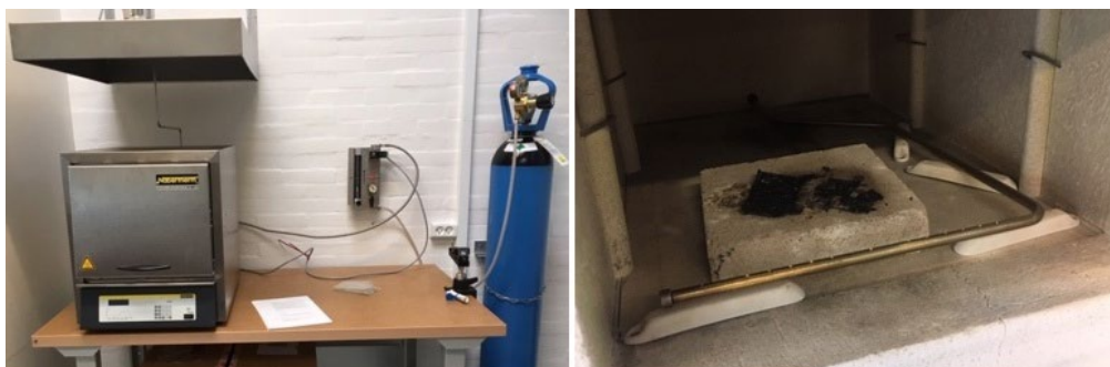
FIGUR 13. Ovnens med "emhætte" over samt trykflasken med nitrogen (venstre). Til højre se selve ovnrummet og det rør med huller som nitrogen-gassen blæses ind i ovnrummet med. Opstillingen er lidt primitiv, men var relativt billig at etablere da selve ovnen eksisterede i forvejen.
