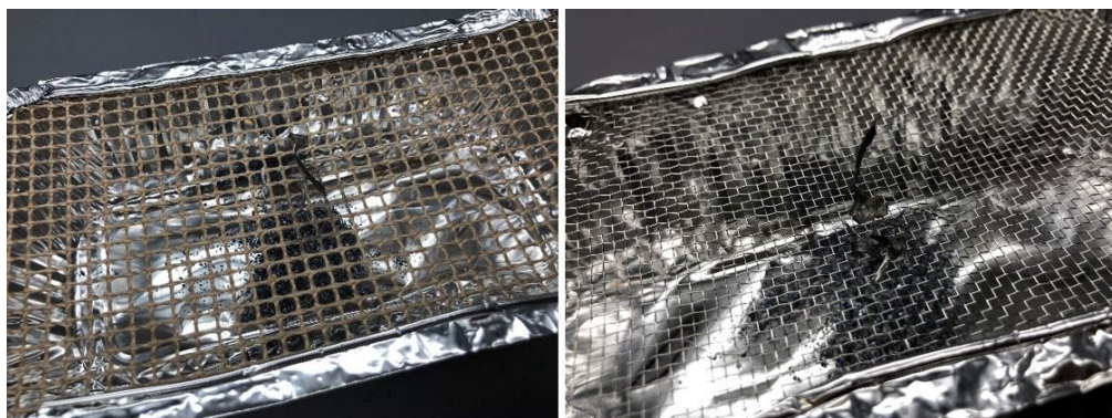
FIGUR 25. Frasortering af de såkaldte busbars (metal strenge) efter pyrolyse med en simpel sigte. I billedet til venstre er afstanden mellem sigtens gitter 5 mm og til højre er den 2 mm. Da metalstregene ikke knuses, som siliciumsolcellen, vil denne fraktion kunne sorteres fra.
