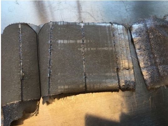
FIGUR 9. Et lille udsnit af det materiale som projektet har modtaget fra NPC i Japan. Billedet viser ca. 3 solceller hvor både glas og bagsidefolie er fjernet mekanisk. Kigger man grundigt efter på billedet, kan man se at også en del af siliciumcellerne er fjernet – da det rå silicium er kommet til syne (grå farve). Dette er naturligvis ikke meningen, men viser dog at maskinen kan fjerne bagsidefolien – den har blot skåret lidt for dybt i dette tilfælde.
