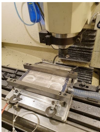
FIGUR 15. Testopstilling til termomekanisk spåntagende adskillelse af bagsidefolie. Processen er her demonstreret ved en test hvor kun det øverste lag EVA og solcellerne er fjernet, men hvor det nederste lag EVA stadig sidder på bagfolien (foto til venstre). Fotoet til højre viser EVA og solcelle rester, fjernet fra bagfolien med spåntagende bearbejdning.
