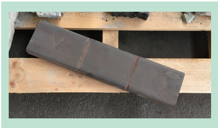
FIGUR 21. Testemne af stål MA253 efter 11 testbrændinger i normal blådæmpningsproces.
