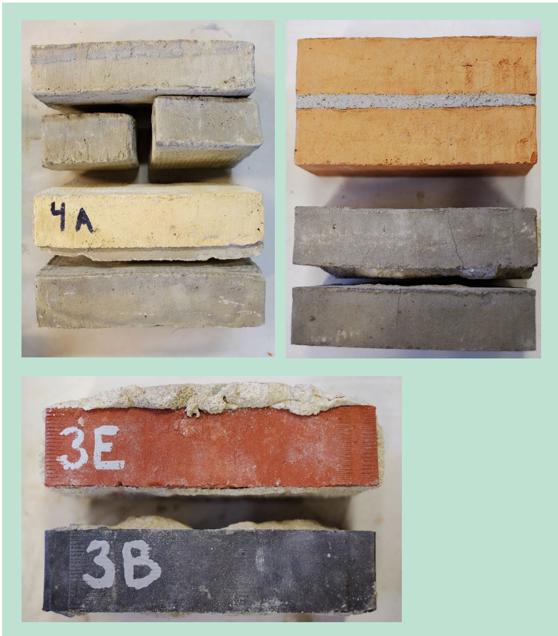
FIGUR 7. Indledende forsøg med brænding af genbrugsmursten under reducerende betingelser for ændring af stenenes farve.
