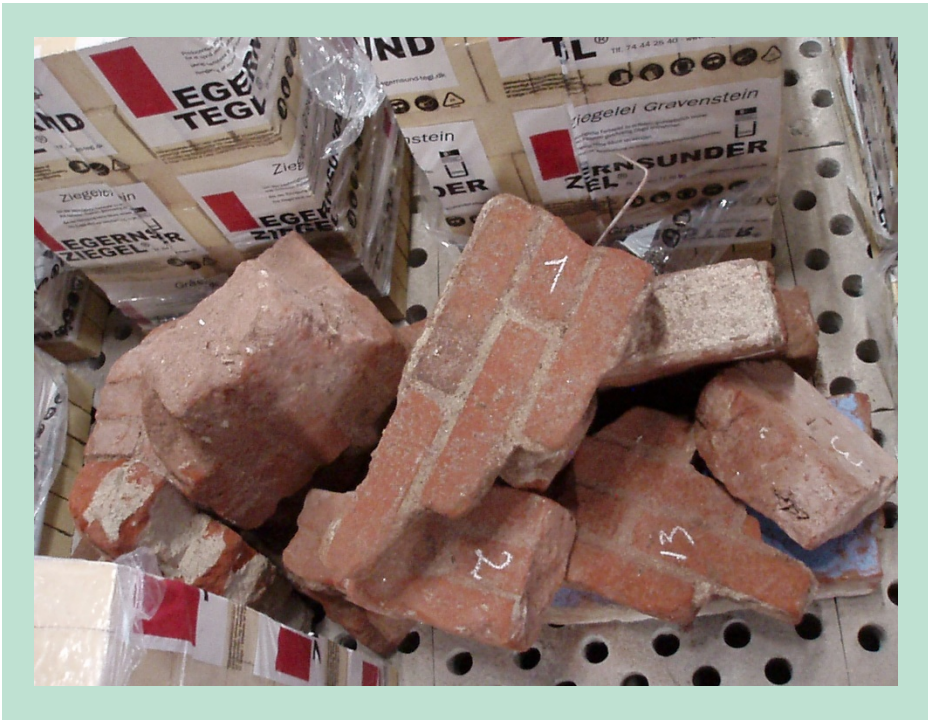
FIGUR 8. Murværksbrokker fra Skejbyvej, Aarhus til genbrænding under reducerende betingelser.
