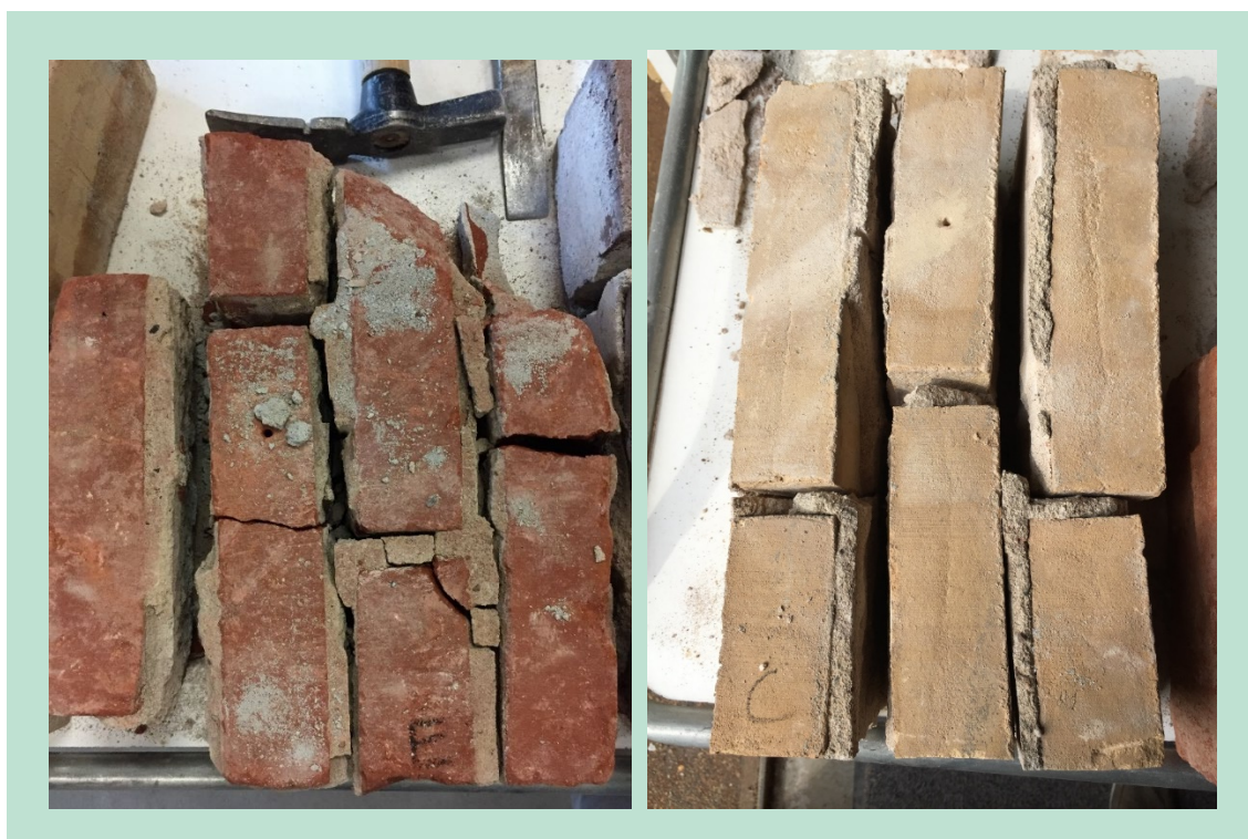
FIGUR 18. Brokker opvarmet udelukkende med mikrobølger og adskilt med hammer og mejsel. Der ses ingen revner i gule mursten, mens der er opstået revner i 3 ud af 4 af de tilnærmelses hele røde mursten.
