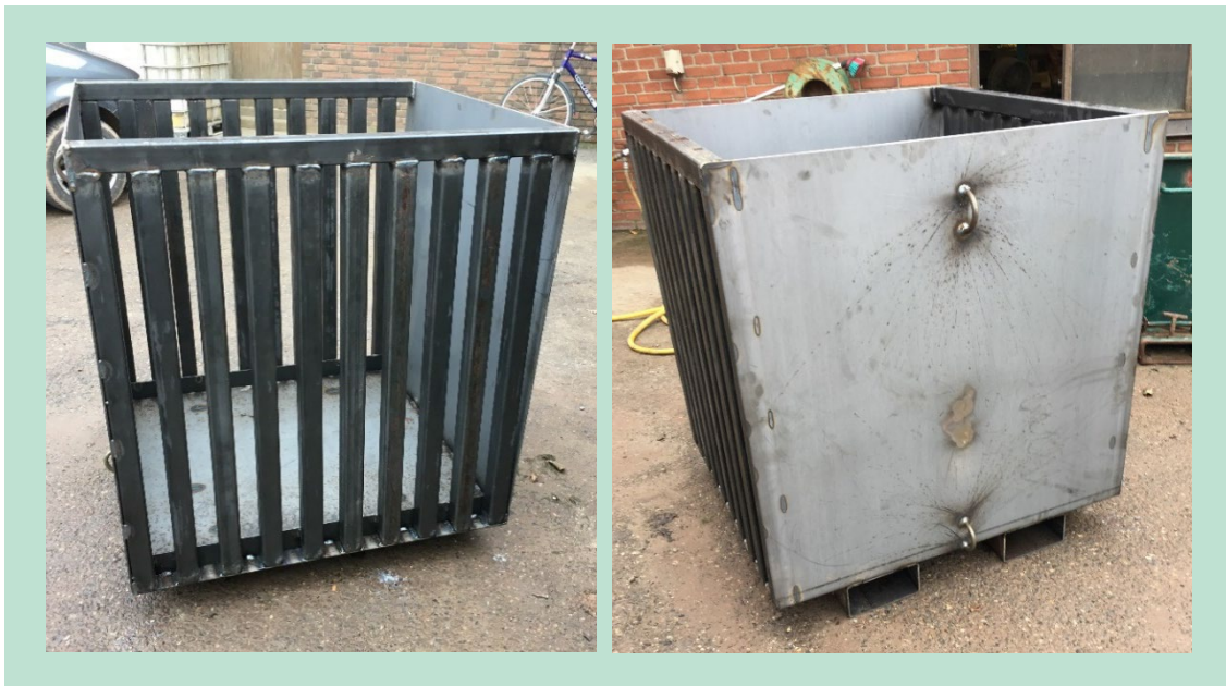
FIGUR 20. Prototype af beholder til håndtering af brokker og mørtelstøv under genbrænding.
