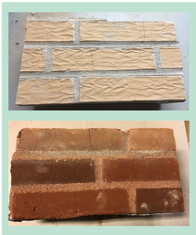
FIGUR 14. Revnedannelse i genbrændte murværksbrokker baseret på murværk i ¼-stens løberforbandt. Øverst ses murværk baseret på gul maskinsten. Nederst ses murværk baseret på røde blødstøgne sten.
