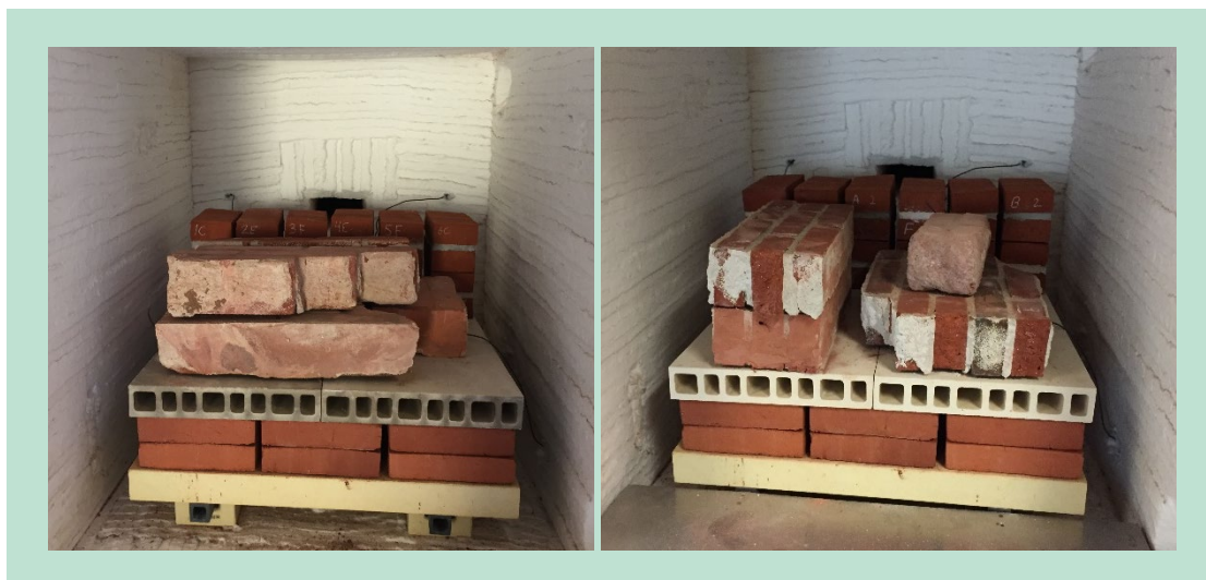
FIGUR 5. Sætning i ovnen for de to pilotskalaforsøg med gasbrænding. Til venstre ses sætningen for forsøg Pilot-550 og til højre ses sætning for forsøg Pilot-700. Aftrækket til skorstenen ses bagest i ovnen.
