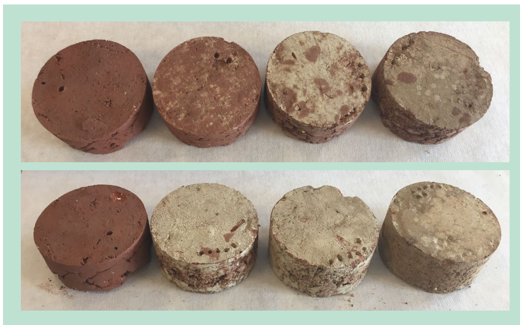
FIGUR 12. Fremstillede sten med restmateriale i form af brændt mørtel. Øverste række viser serien med tilsat mørtel brændt ved 550°C. Nederste række viser serien med tilsat mørtel brændt ved 850°C. For begge serier gælder, at emnet længst til venstre er referencen med ren ler - herefter ses stigende indhold af brændt mørtel fra venstre til højre med 5, 10 og 15%.
