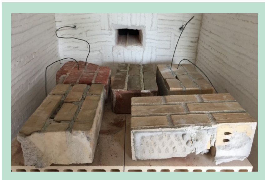
FIGUR 16. Placering af murbrokker og termofølere i forsøg med ren mikrobølgeopvarmning.
