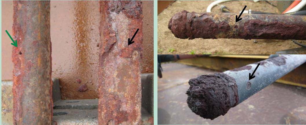
FIGUR 10. Indblæsningsrør til beluftning af jorden under opvarmningen. Rørene er tydeligt tæ- rede og en del huller til indblæsning er reduceret i størrelse eller helt blokeret af rust. I de yderste 1,5 m er alle huller på alle 10 rør blokeret af fastsiddende rust.
