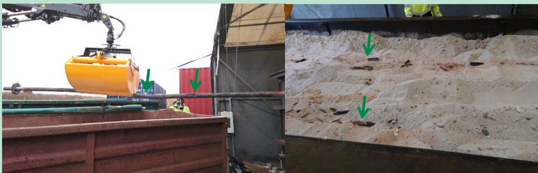
FIGUR 9. Varmelegemernes yderrør er noget svækket efter pilotforsøget og bliver let klemt og bøjet (venstre) og tykke stykker glødeskaller af jernoxid falder af ved håndteringen (højre).
