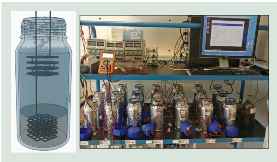
FIGUR 21. Forsøgsopstilling for bioelektrodeforsøgene til undersøgelse af TBT nedbrydning i havnesediment. A) er en skitse af designet, mens B) viser forsøgene som opsat i laboratoriet.
