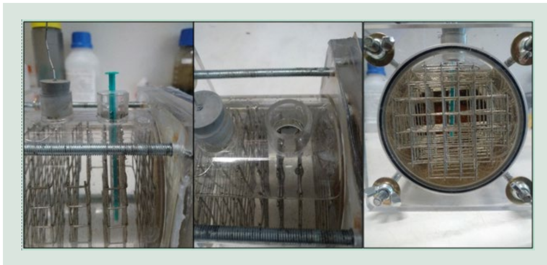
FIGUR 6. Elektrode testopstilling til test af materialer og laboratorieskalaforøg.
