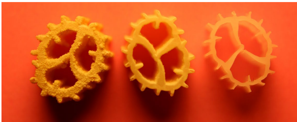
FIGUR 20. Filtermateriale bioflow9 fra forskellige stadier af coating. Yderst til højre det rene filtermateriale, i midten prøve med 175 kg kalk pr. m 3 (udtaget 2. oktober 2019) og til venstre prøve med 255 kg kalk/m 3 (udtaget 15. december 2019). Filtermaterialets tilvækst skyldes dets strukturelle stabilitet der gør det svært at deformere og rense.
