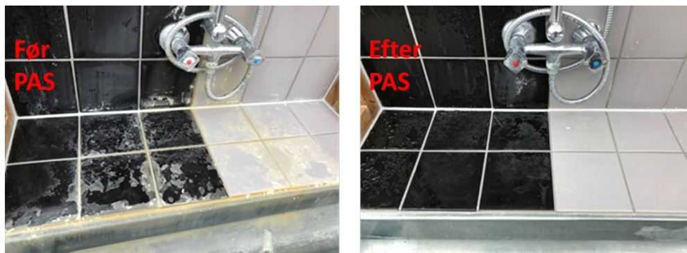
FIGUR 2. PAS formindsker kalkfældningen i det varme vand – forsøg udført for Frederiksberg Forsyning.
