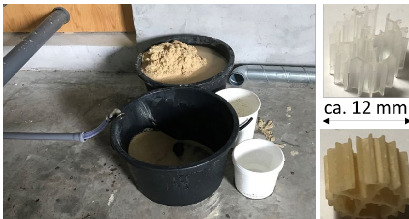
FIGUR 15. Udtagning af kalkflager fra PAS-2A (opstrøms flow), filtermateriale er Curler Advance X1 (polypropylen). Den åbne periferi letter deformationen af filtermediet og bidrager til at kalkflagerne slipper mediet.
