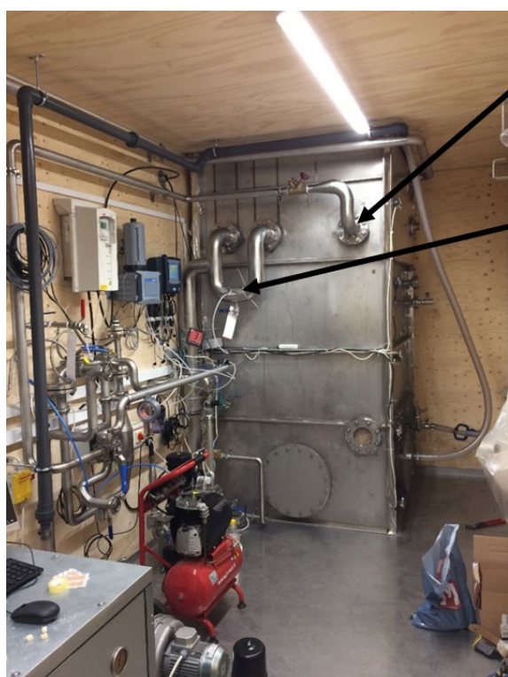
FIGUR 5. PAS-2 pilotanlægget indvendigt efter ombygning med PAS-reaktoren i baggrunden.
