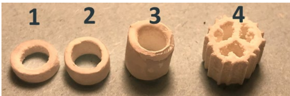
FIGUR 23. Filtermaterialer belagt med gips, som er anvendt i opløsningstest i kolonneforsøg til bestemmelse af mass-transfer rater. Nr. 1 – 3 er ø 8/6 mm Raschig ringe med højde 2,6 mm, 4,0 mm og 8,0 mm. 4 er Bioflow9.
