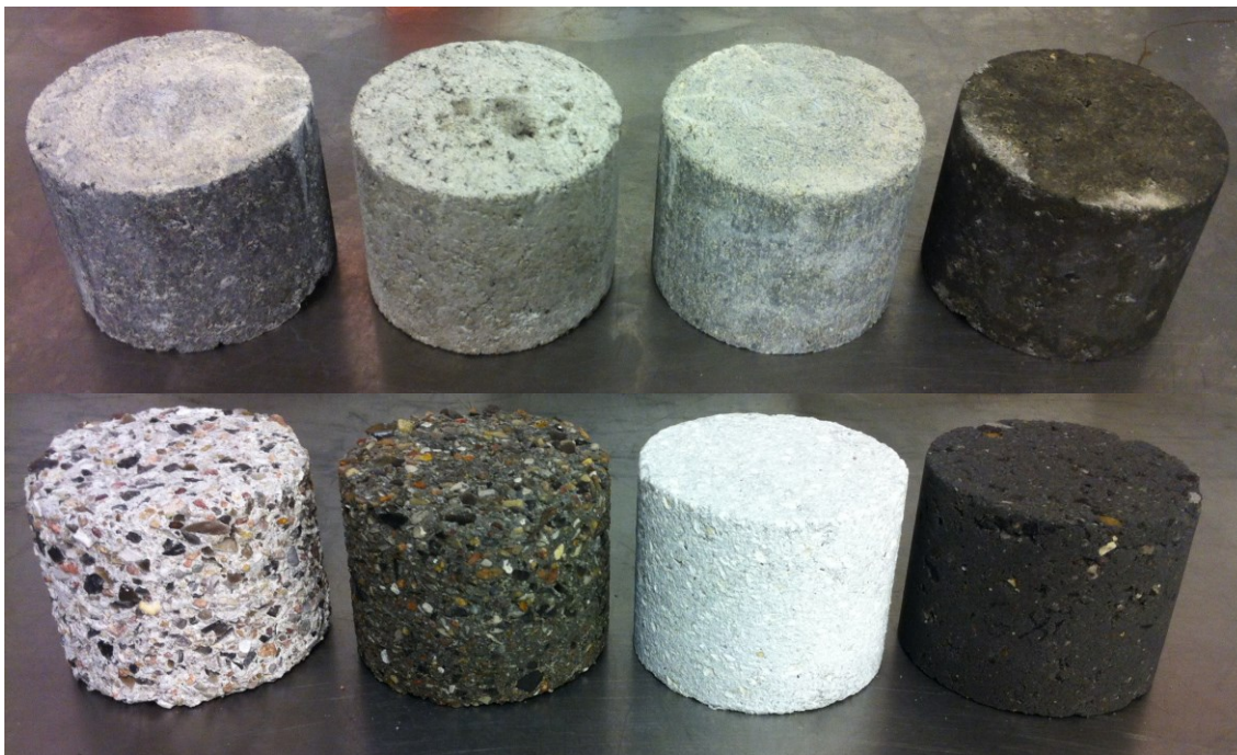
FIGUR 3 PRØVEEMNER EFTER SYRETEST (NEDERST) OG REFERENCEPRØVER OPBEVARET I VAND (ØVERST). FRA VENSTRE MOD HØJRE ER DET REFERENCE, CALCIUM ALUMINATE CEMENT, KALKSTEN OG GEOPOLYMER.
