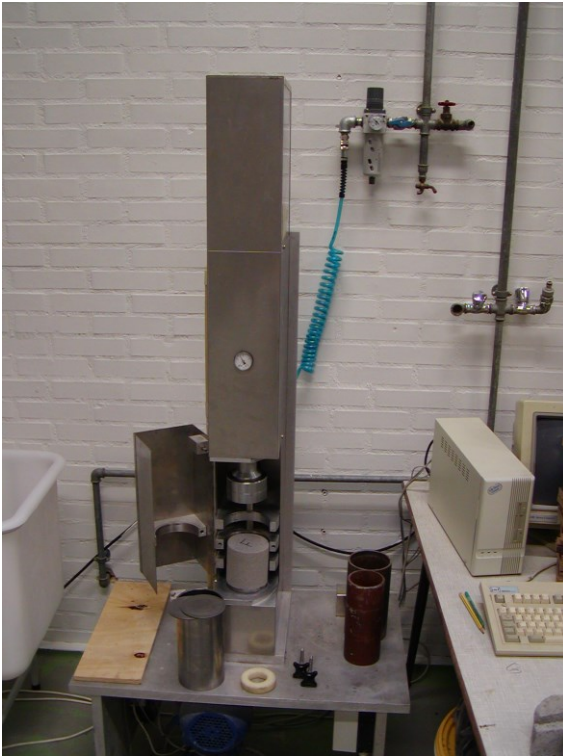
FIGUR 1 KOMPAKTOR TIL FREMSTILLING AF PRØVEMENER AF TØRBETON
