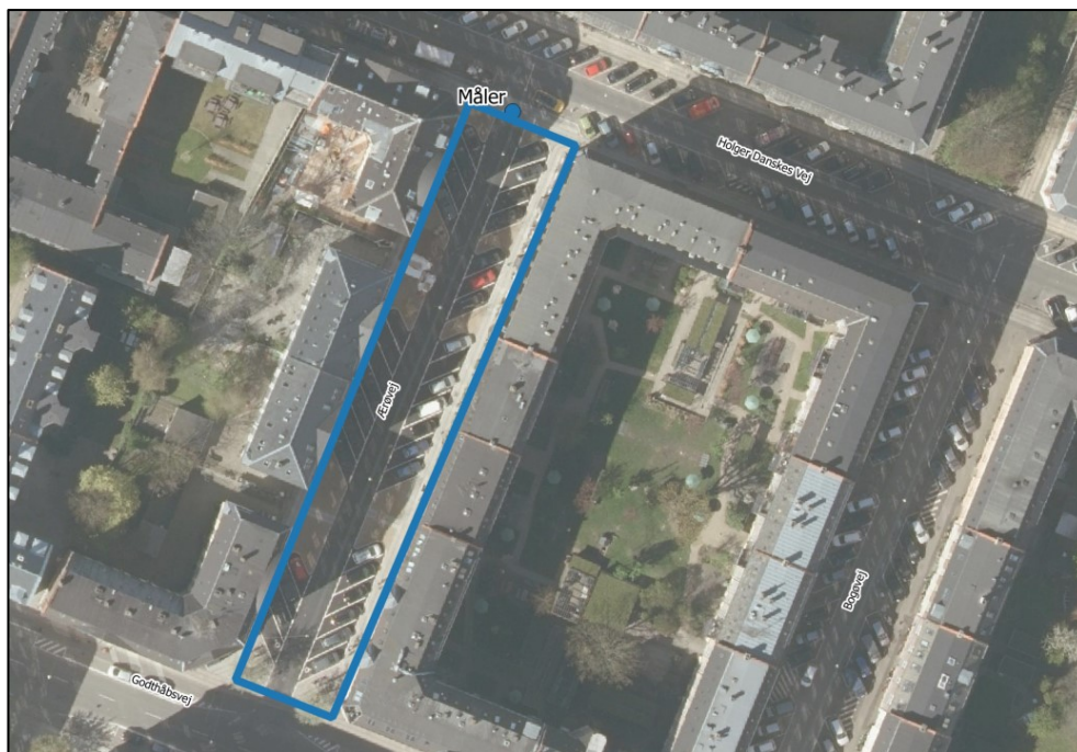
Figur 20 Placering af brønd hvor der har været installeret flowmåler, samt omtrentligt opland for brønden.
