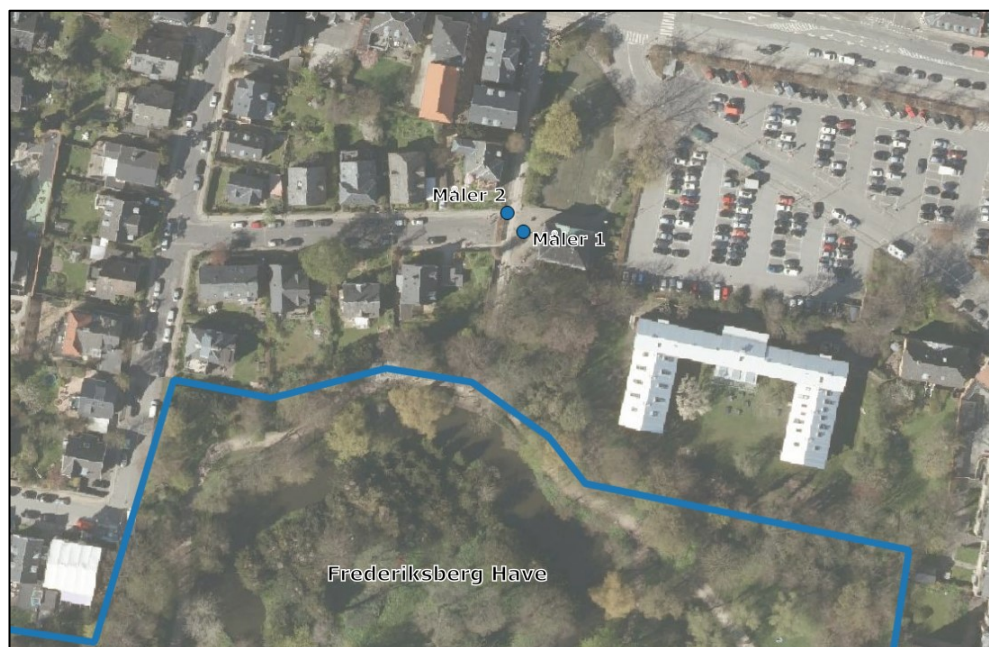
Figur 7 Placering af brønde hvor der har været installeret flowmålere. Måler 1, vurderes at repræsentere udløbet fra Frederiksberg Have
