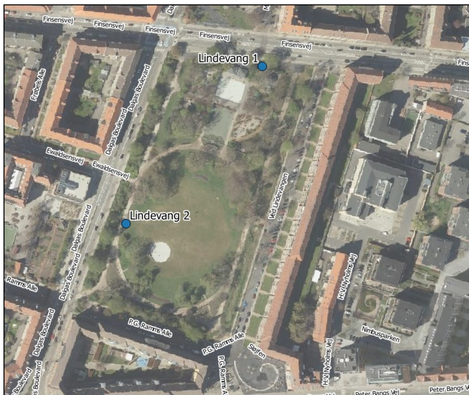
Figur 32 Omtrentlig placering af de to brønde hvori der var installeret flowmålere, ved indløbet til Lindevangsparken, og efter overløb fra faskinen.
