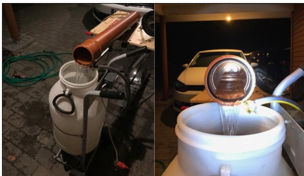
Figur 3 Testopstilling for installation af sensorer før de monteres i kloakken
