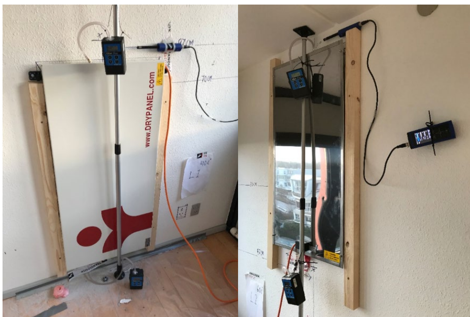
Udtagning af luftmålinger under og over varmepanelet samt måling af temperatur og luftfugtighed på vægoverfladen over panelerne (40 °C panel til venstre og 60 °C panel til højre).
