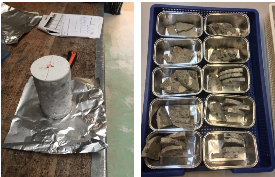
En af betonkerne udtaget fra Lille Værløse Skole, samt betonkernen efter opskæring i 10 dybdeintervaller.
