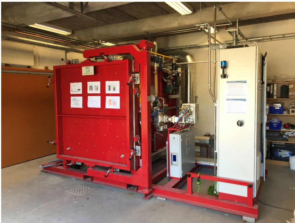
Mikrobølgeovn anvendt til forsøg med rensning af PCB-forurenede byggeaffald.
