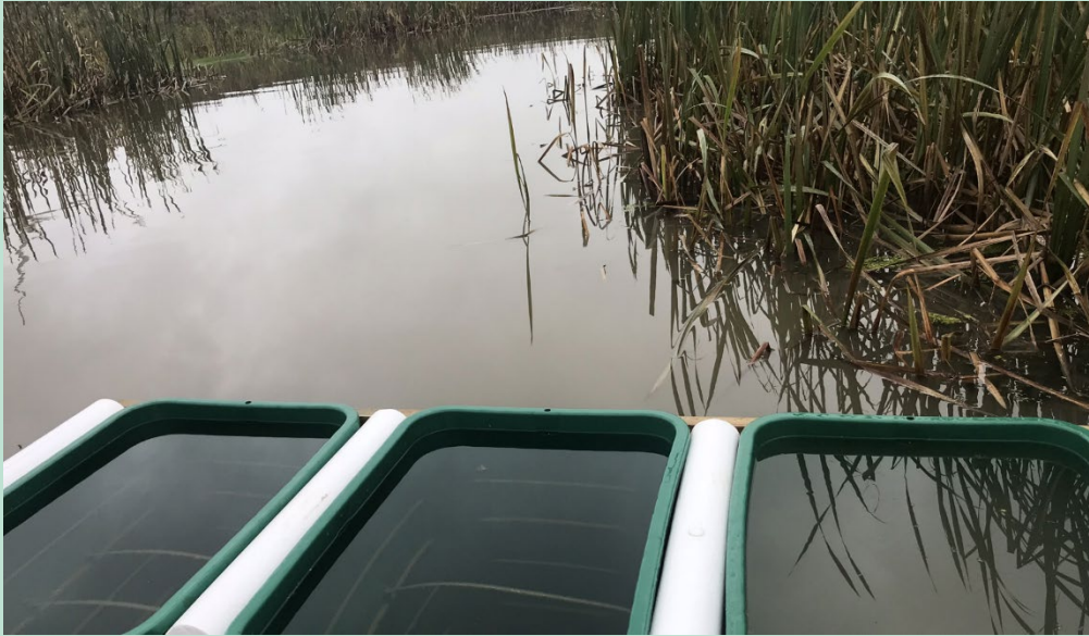
FIGUR 14. Tre testbassiner installeret i det sydlige våde regnvandsbassin ved Silkeborgmotorvejen.
