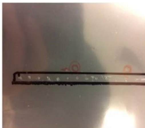
FIGUR 14. Foto af perforeringer i matrixfolie og topfolie. De røde cirkler som markerer mikroperforeringerne i BOPP-folien og det sorte rektangel som markerer PE-foliens makroperforeringer.
