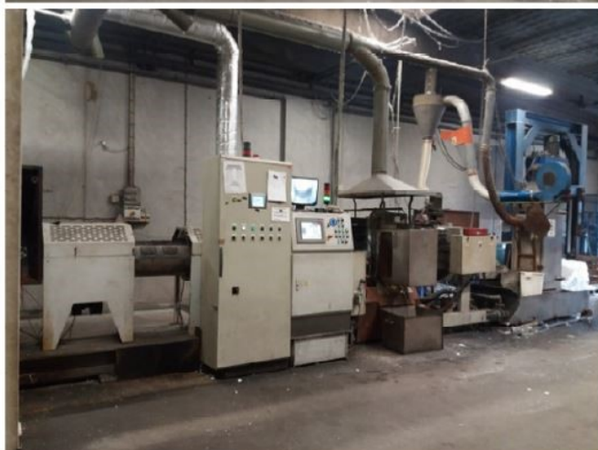
Billede 5.2.3.1: Produktionslinje anvendt hos Aage Vestergaard Larsen til produktion af polystyren regranulat
