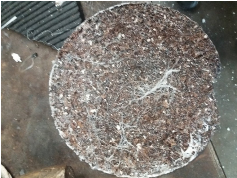
Billede 5.3.3.2: Eksempel på tilstoppet filter, som giver produktionsstop, i forbindelse med processering hos Aage Vestergaard Larsen i projektet.
