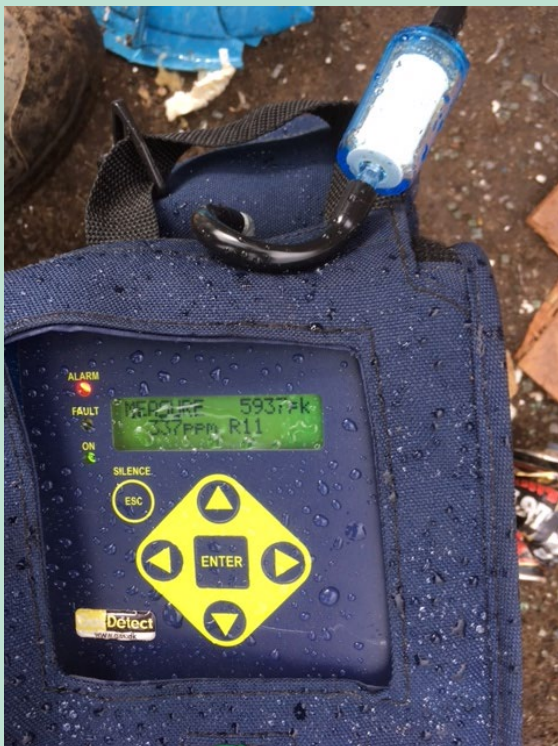
FIGUR 23. Eksempel på indgangskontrol udført hos Stena Recycling. Rørene blev målt til at indeholde CFC-gas, da peakværdien (pk) er 5.937 ppm, hvilket er et godt stykke over grænseværdien på 1.000 ppm.
