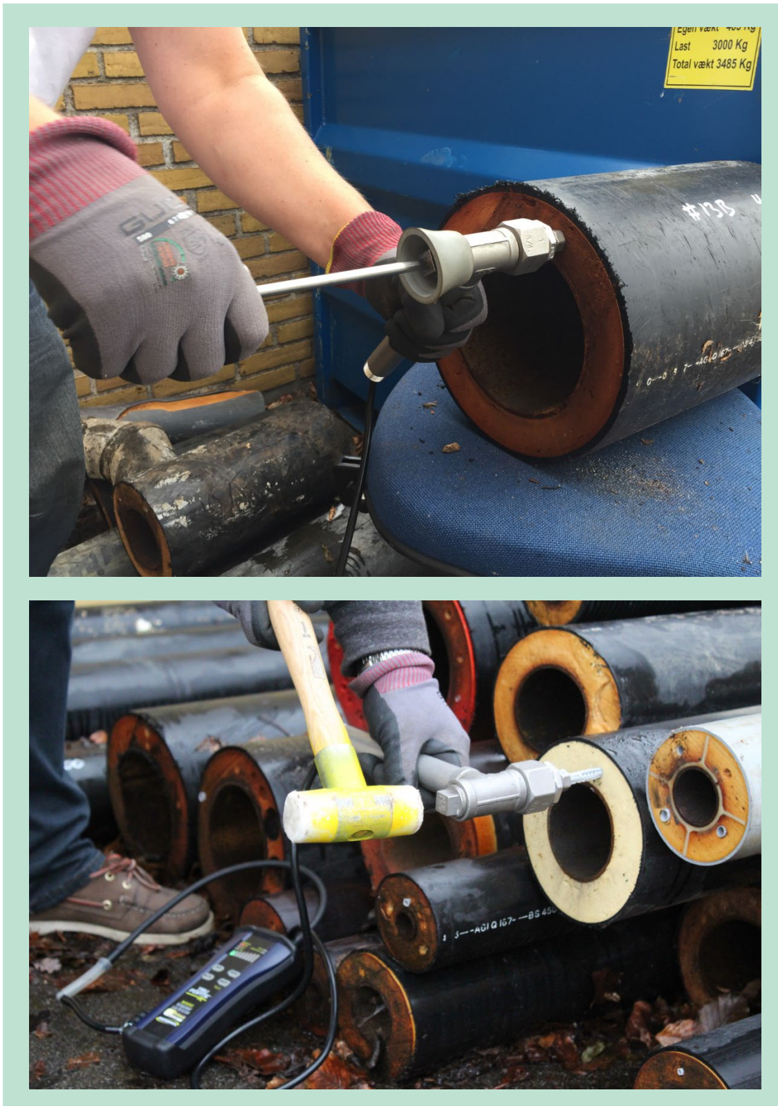
FIGUR 20. Udvikling af metode og måltagning på fjernvarmerør hos Teknologisk Institut i Aarhus. Øverst testes slaglodet til at hamre rawlpluggen i skummet. Nederst benyttes en nylonhammer til samme formål.
