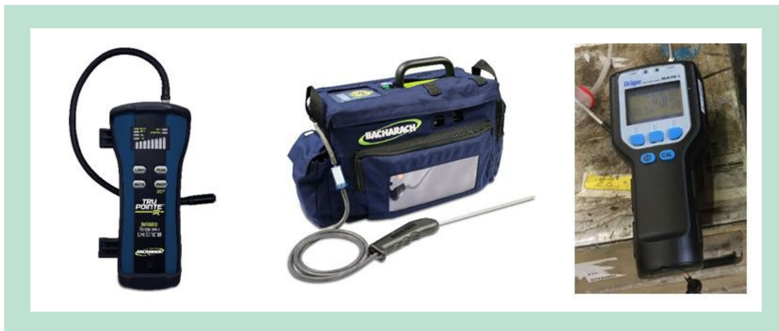
FIGUR 3. De tre måleinstrumenter: Tru Pointe IR (venstre), PGM-IR (midten) og PID-sensoren (højre).
