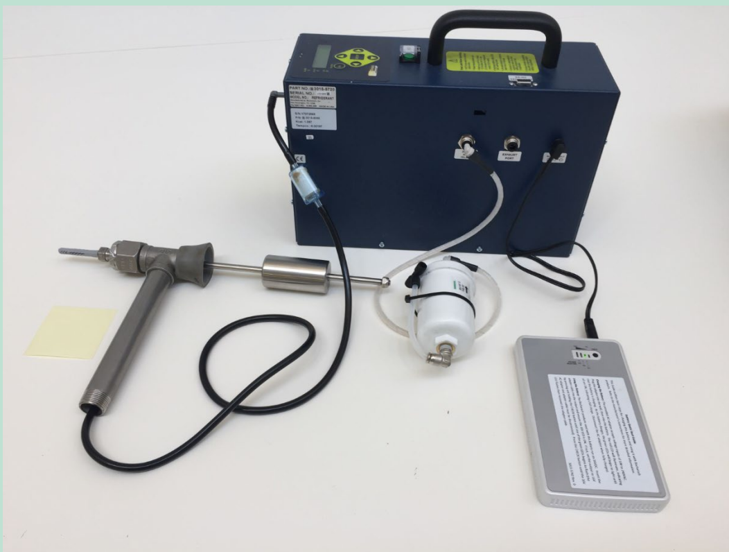
FIGUR 12. Den komplette pakke til udførelsen af målemetoden (vist uden taske på måleinstrumentet).
