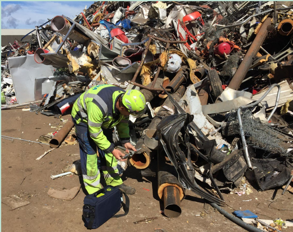
FIGUR 22. Eksempler på måletagning på et fjernvarmerør på pladsen hos Stena Recycling i Grenaa.
