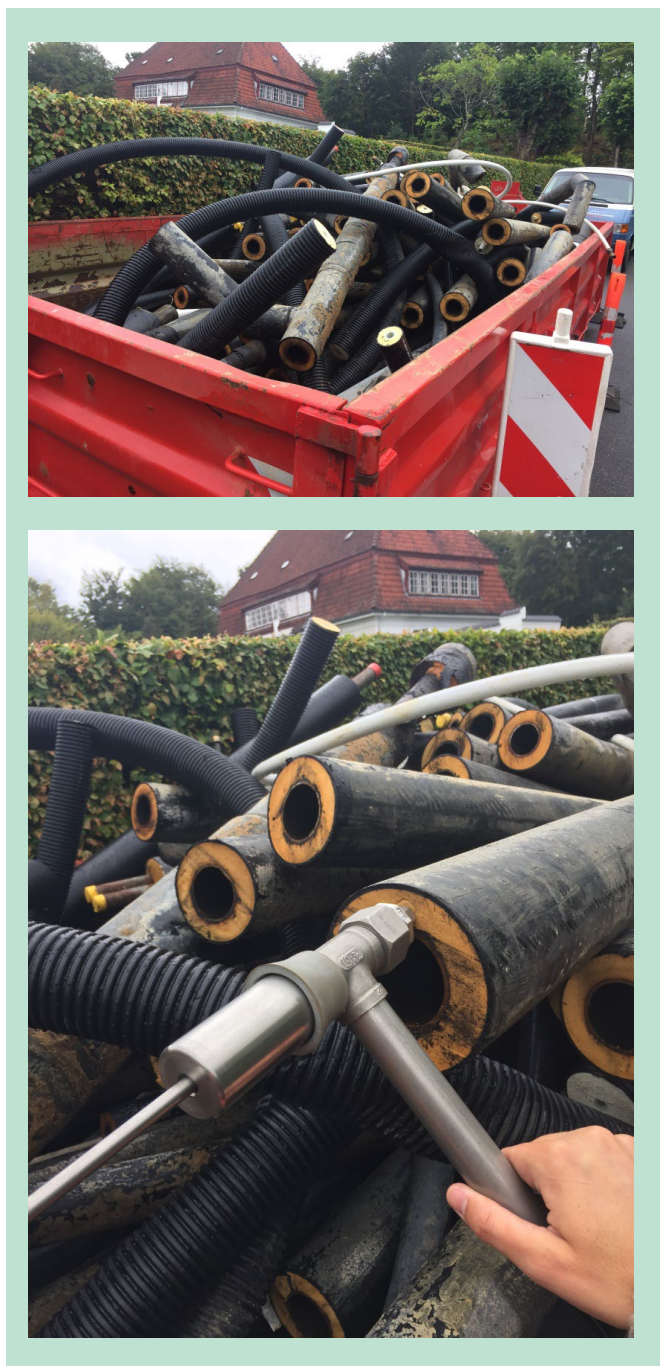
FIGUR 24. Målinger udført på Harestien i Aarhus d. 14/8 2018 på rør samlet i container efter opgravningen.
