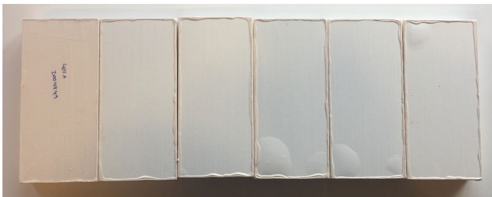
Billede 3: Blæredannelse efter EN 927-5 test ved brug af 25 % siloxanbaseret binder som grunder.
