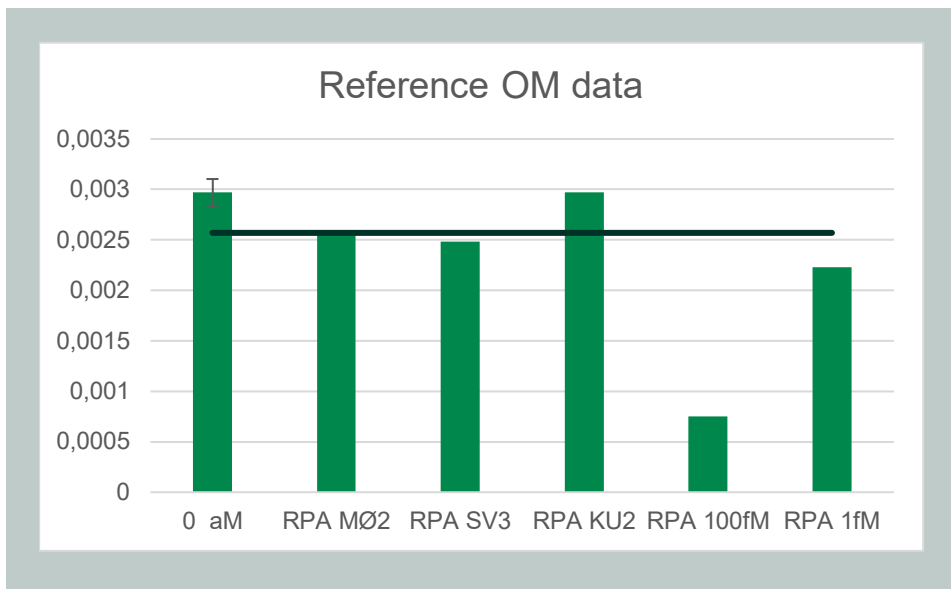
FIGUR 13. RPA-reaktioner udført i reference opto-magnetisk system. RPA-reaktioner af prøver fra Kalundborg vandforsyning (MØ2, SV3 og KU2, se afsnit Fuld skala, Kalundborg Forsyning 7.1.2) og af negative kontrol (0 aM) samt positive kontroller (1 fM og 100 fM). Linjen er middelværdien af den negative kontrol minus tre gange standardafvigelsen (3 replikationer).
