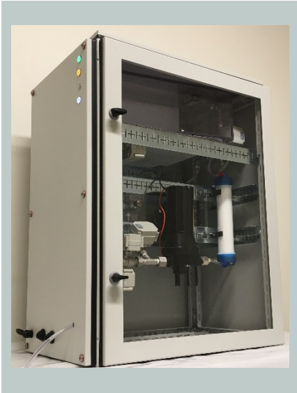
FIGUR 4. Prototype af HiVoSa, der er anvendt til opkoncentrering af vandprøver hos kalundborg Forsyning.
