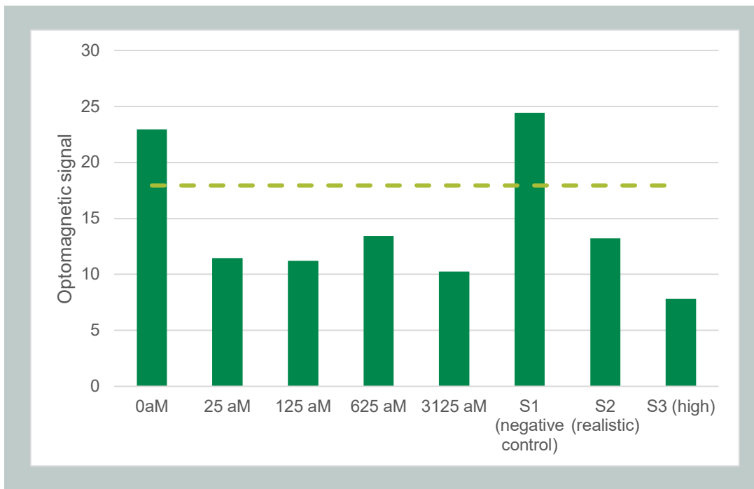
FIGUR 12. RPA-reaktioner udført i BluBox. S2 og S3 er vand prøver spiket med E. Coli opkoncentreret og DNA'et ekstraheret (se afsnit 7.1.1). S1 er en opkoncentreret negativ kontrol.
